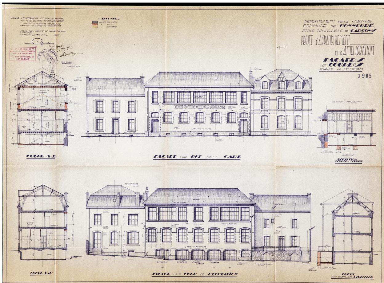
Les plans d'un projet d'agrandissement de l'école (non réalisé), surélévation des classes, par R. Gagnault, 1937.
