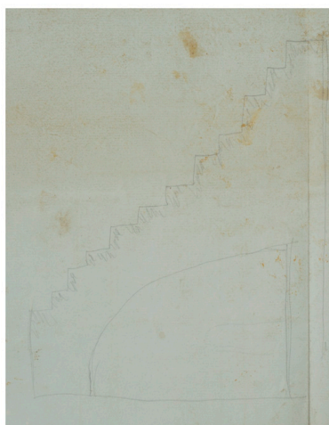
Esquisse de l'escalier intérieur au verso du plan du Moulin Perrotteau joint au marché de construction passé le 14 octobre 1791. Autr. Antoine (?) Rouiller, Phot. Bruno Rousseau, Phot. Youenn (reproduction) Communeau IVR52_20114902016NUCA
