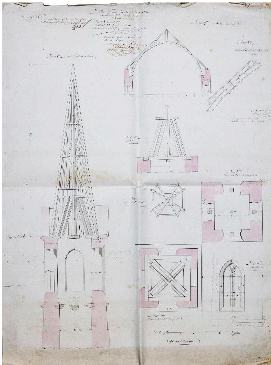
Projet de reconstruction (réalisé) : coupe du clocher et de la flèche, plans et élévations de la charpente de la flèche, plan de la base maçonnée de la flèche, fenêtre du clocher-porche, élévation et détail d'assemblage d'une ferme de charpente de la nef.
