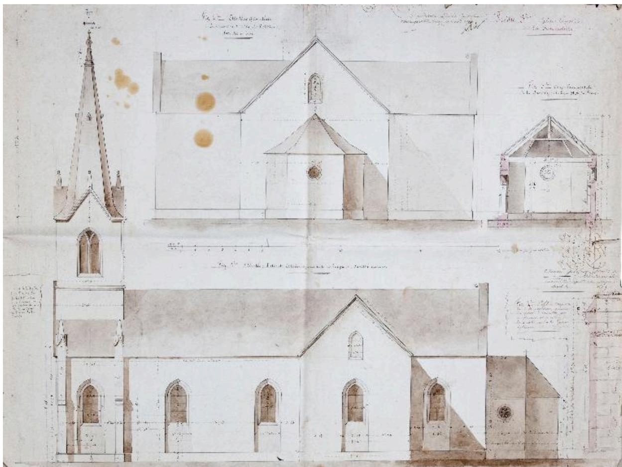
Projet de reconstruction (réalisé) : élévation sud, élévation est, coupe transversale de la sacristie, profil du socle extérieur.
