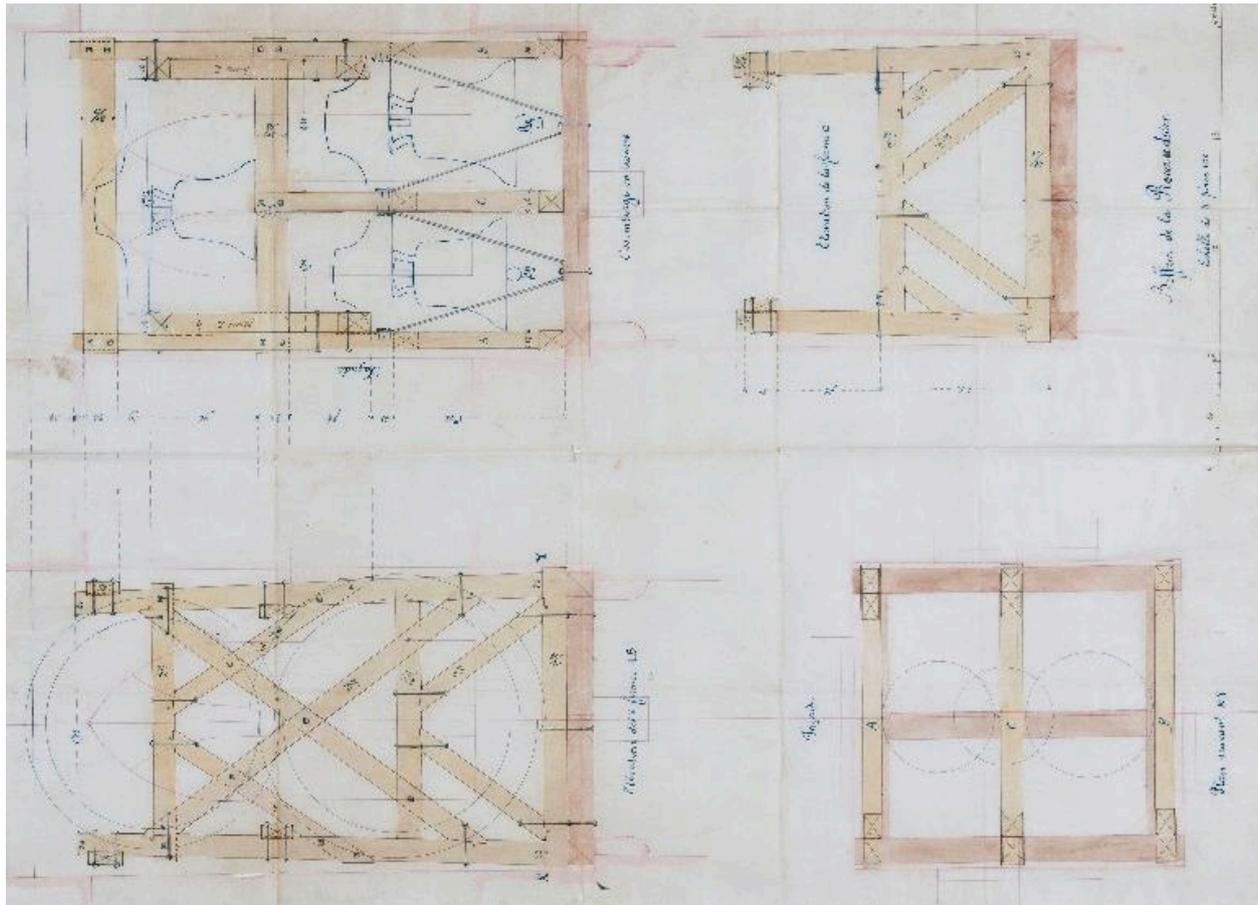
Projet de réaménagement du beffroi en vue de l'installation d'une troisième cloche (non réalisé) : plan et coupes.
