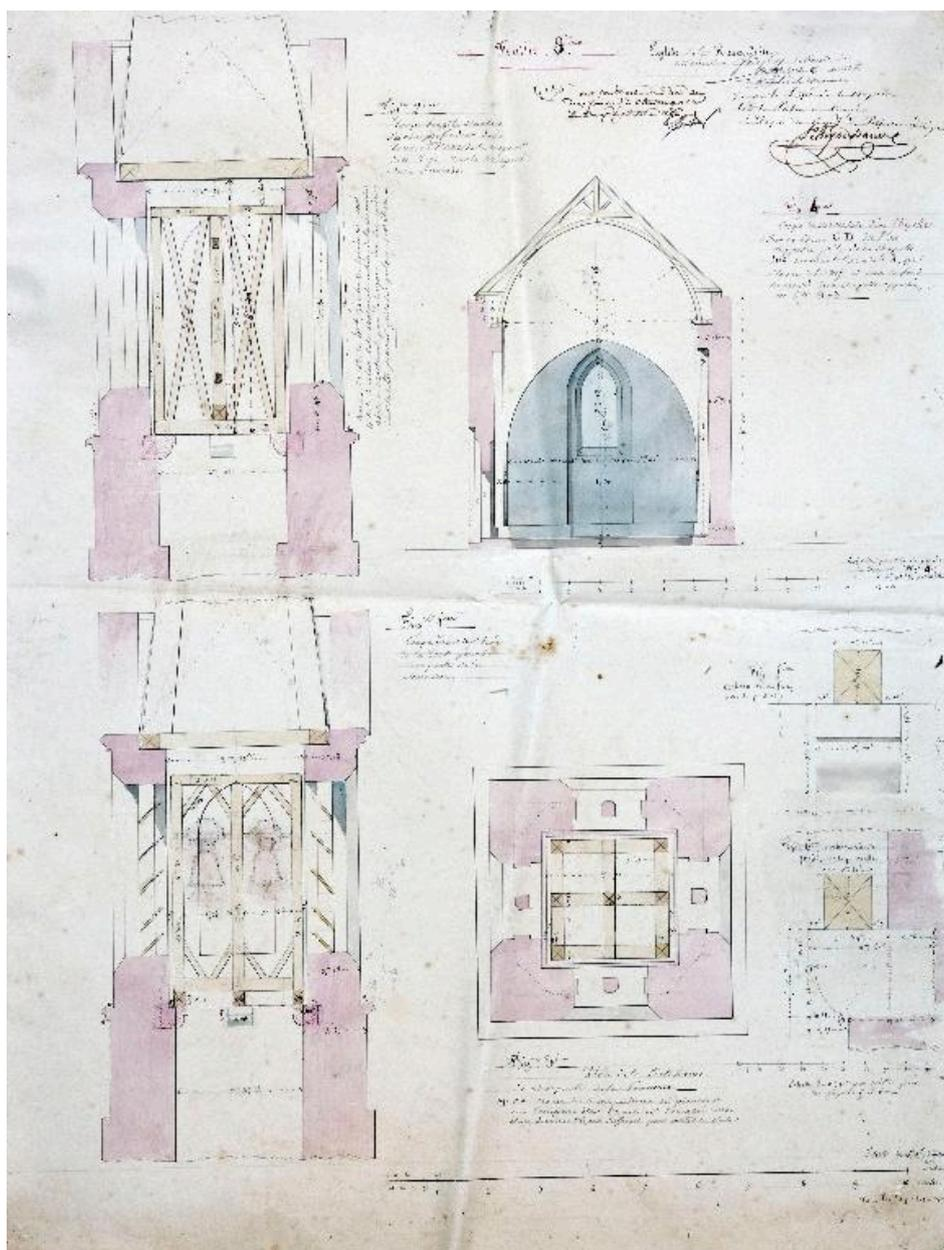
Projet de reconstruction (réalisé) : plan et coupes de la chambre des cloches, coupe transversale d'une chapelle, face et profil des corbeaux.
