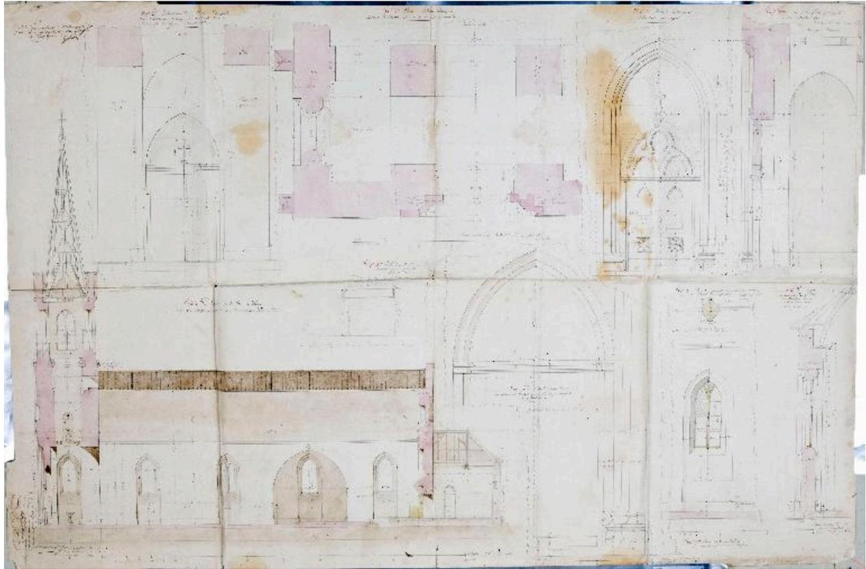
Projet de reconstruction (réalisé) : coupe longitudinale, plan partiel du clocher-porche, élévation de la porte principale, coupes longitudinale et transversale du porche, élévation intérieure et coupe d'une fenêtre, plan du meneau d'une fenêtre.
