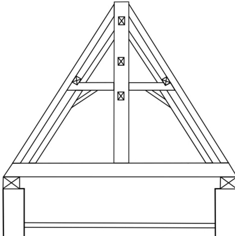
Elévation schématique d'une ferme de la charpente du pavillon.
