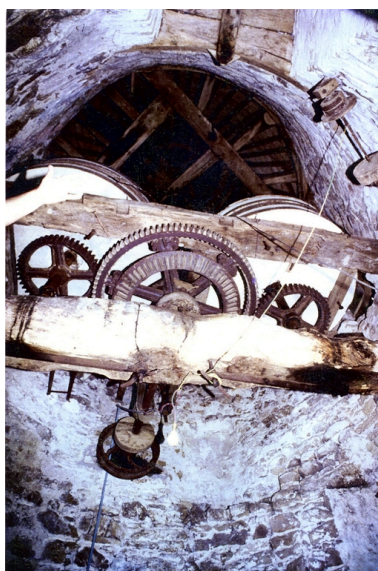
Moulin de Beaulieu. Vue intérieure de la tour de bas en haut. Le palier supportant le gros-fer et le hérisson de distribution du mouvement aux deux petits-fers des couronnes. Au-dessus, les deux paires de meules. Josick Lancien, 1990. Phot. Denis (reproduction) Pillet IVR52_20094401449NUCA
