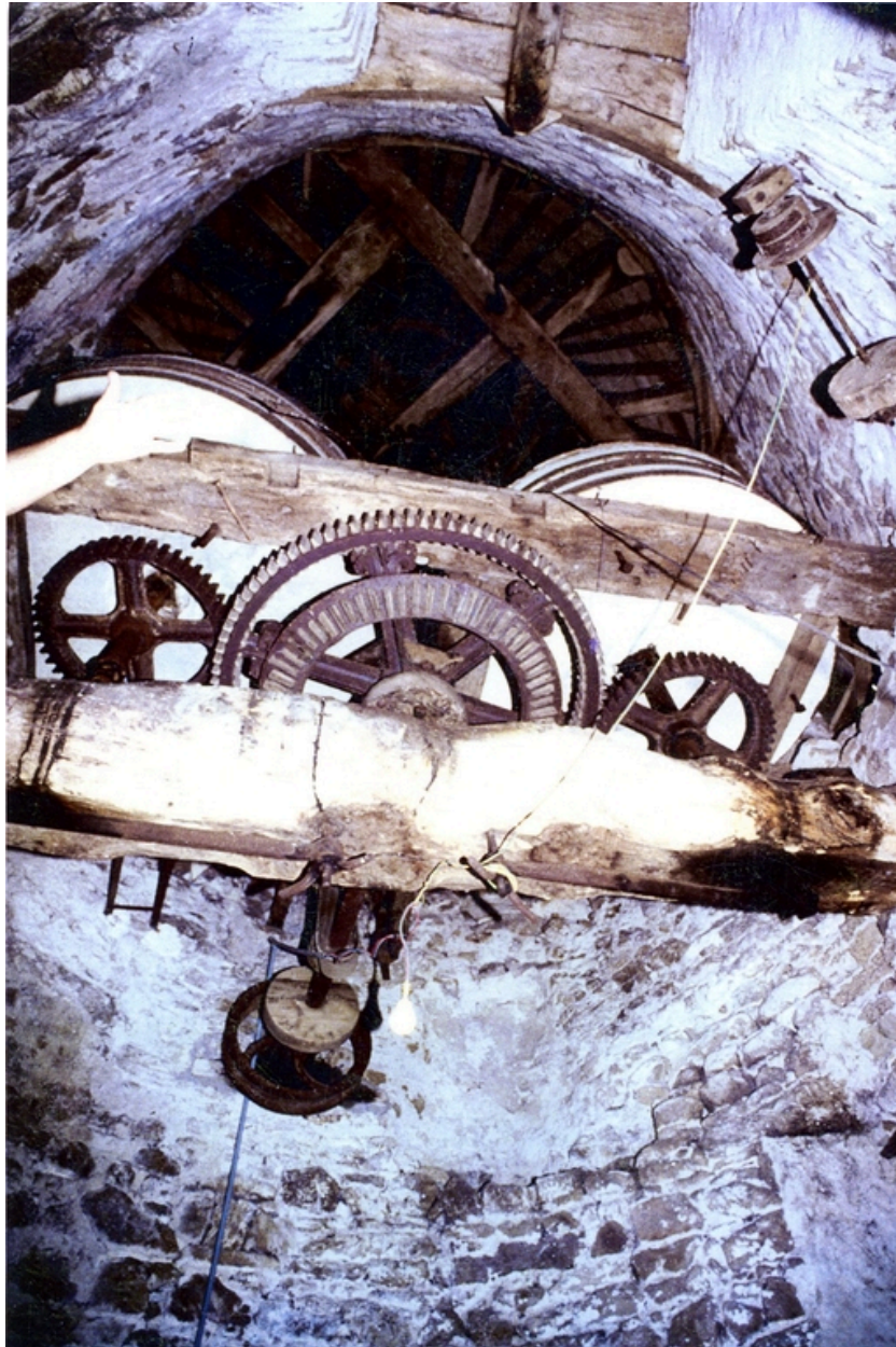
Moulin de Beaulieu. Vue intérieure de la tour de bas en haut. Le palier supportant le gros-fer et le hérisson de distribution du mouvement aux deux petits-fers des couronnes. Au-dessus, les deux paires de meules. Josick Lancien, 1990.
