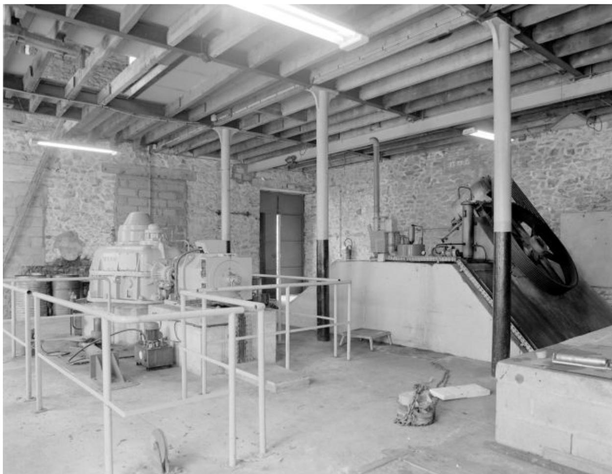
Vue d'ensemble du rez-de-chaussée depuis le nord-est : à gauche, le multiplicateur et le générateur est ; à droite, ceux de l'ouest.
