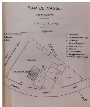
Plan de la laiterie de Damvix à l'occasion de la construction du bâtiment de production de poudre de lait, 1962.
