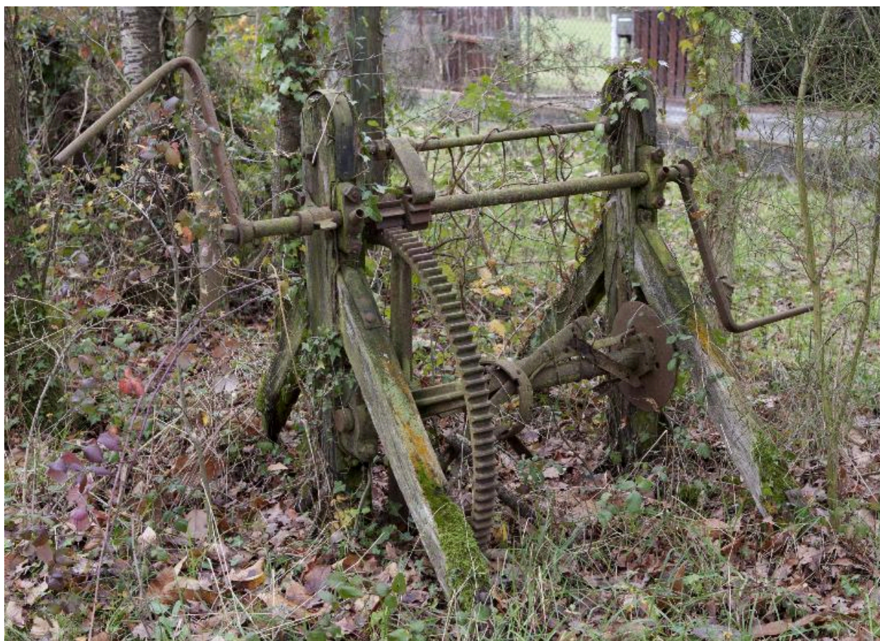
Treuil à structure bois, Ardoisière de Nozay (Loire-Atlantique).
