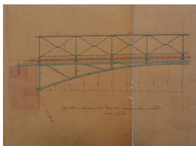
Projet de passerelle sur le canal de la Vieille Autise, par Espitallier, 24 juin 1868 : demi-élévation de la passerelle.
