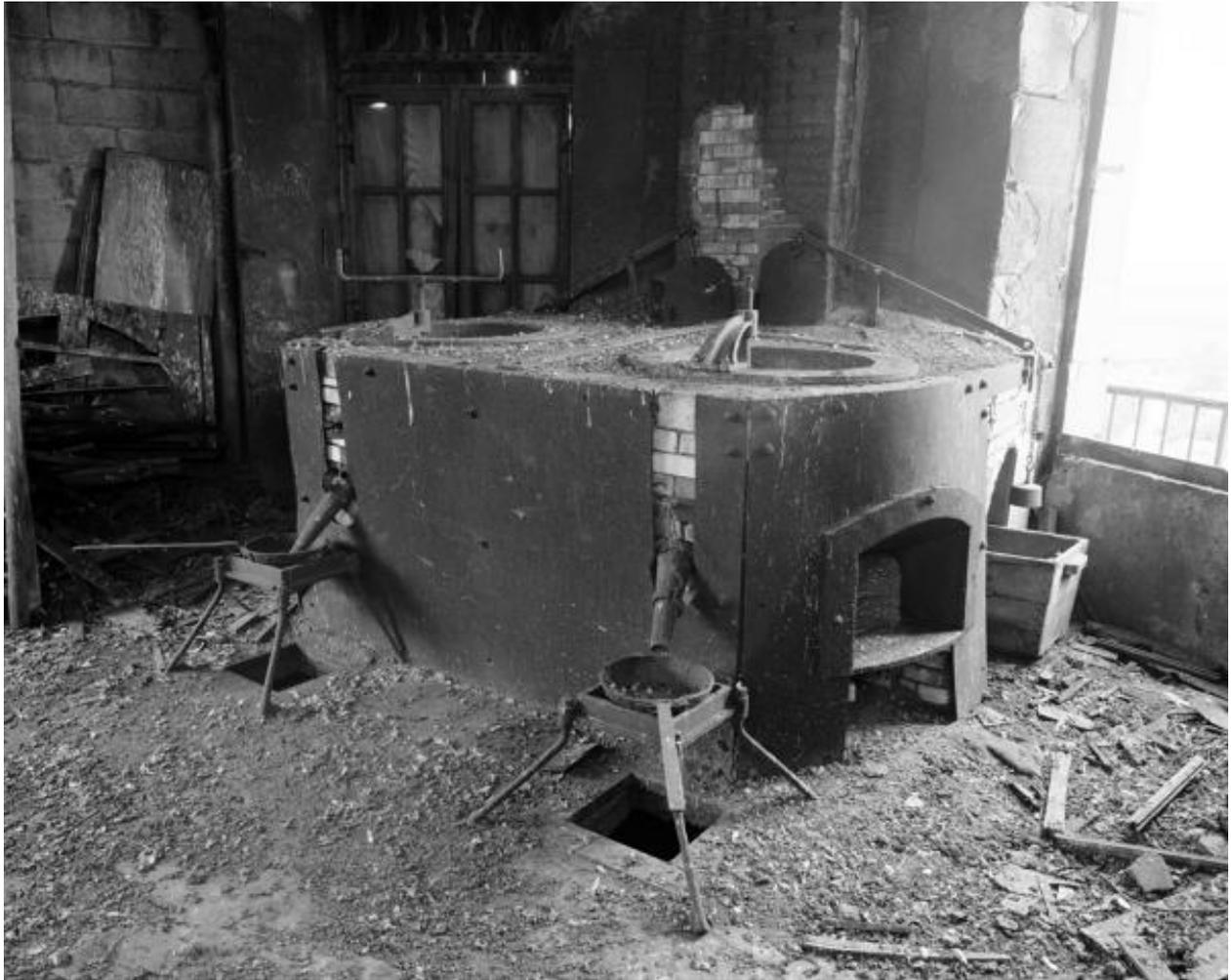
Vue des fours de fusion des lingots de plomb.
