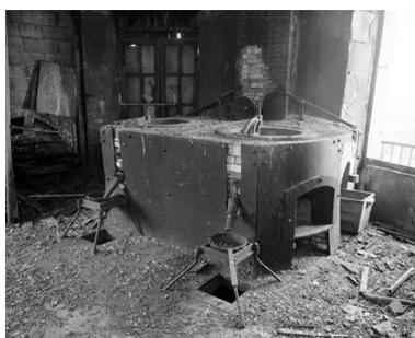
Vue des fours de fusion des lingots de plomb.
