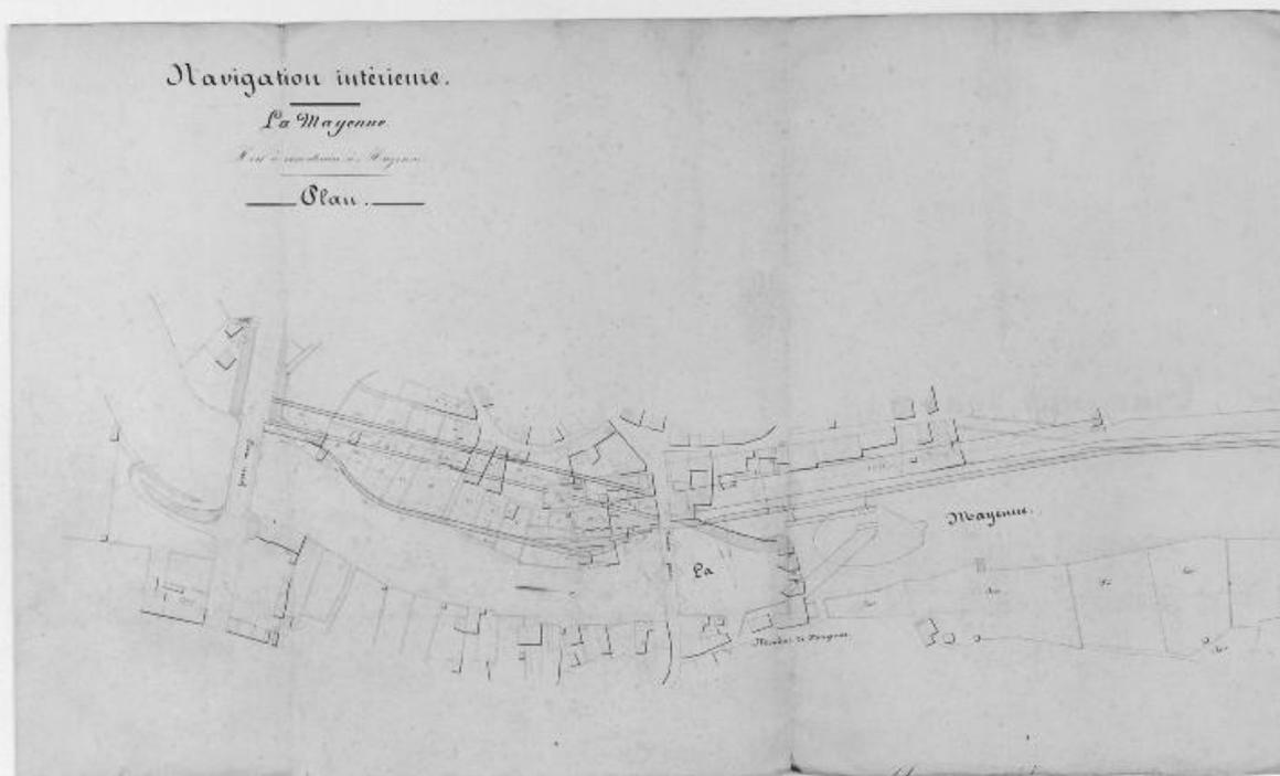
Projet de réalisation d'un quai et d'un port, rive gauche. Premier projet (non réalisé) de construction d'une écluse à sas à l'emplacement de l'ancienne chaussée.
