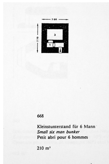
Plan d'un blockhaus de type H 668. Abri pour 6 hommes (210 m 3 ). Phot. Denis (reproduction) Pillet IVR52_20074401173NUCA
