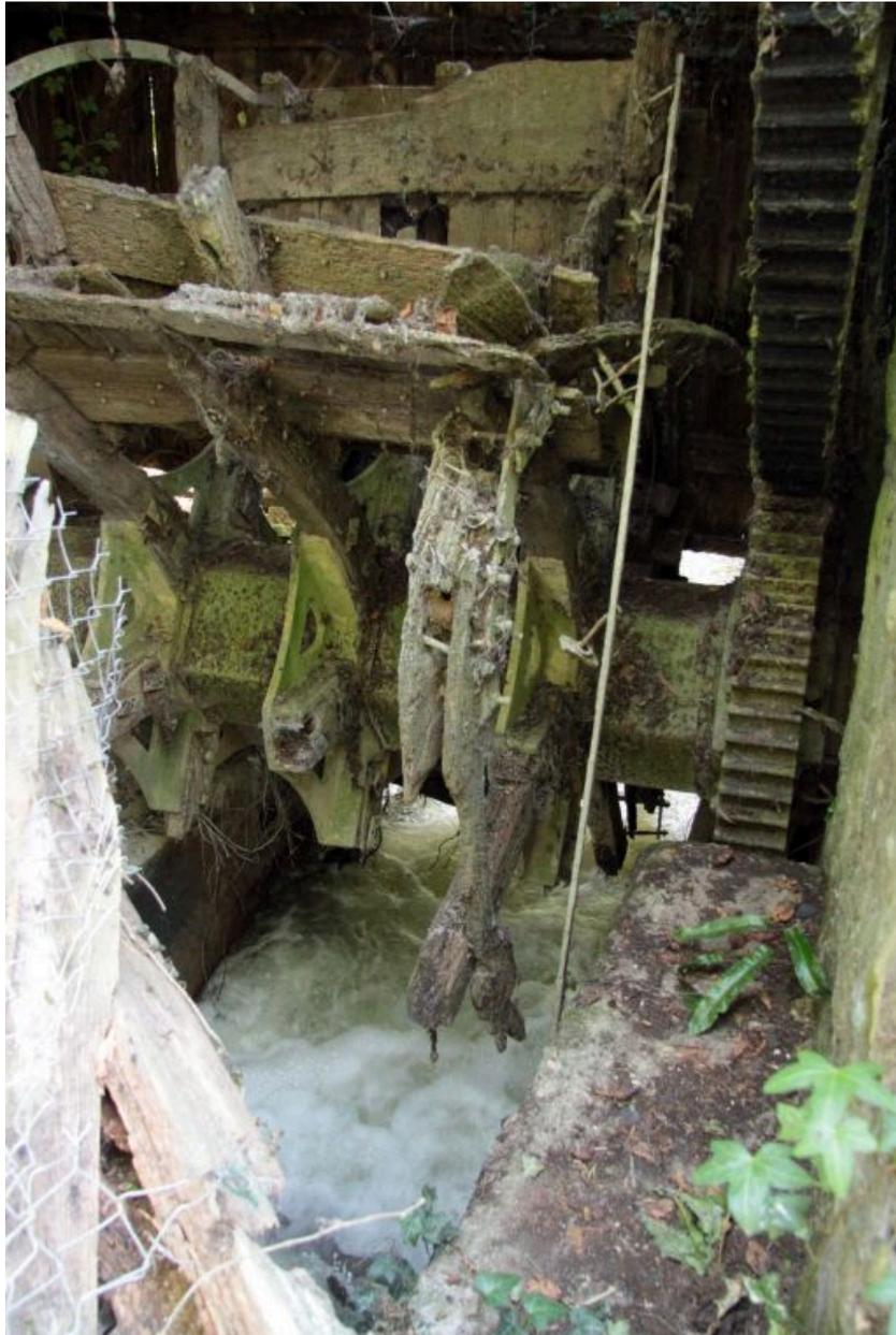
Les engrenages de la roue au contact avec le tympan.
