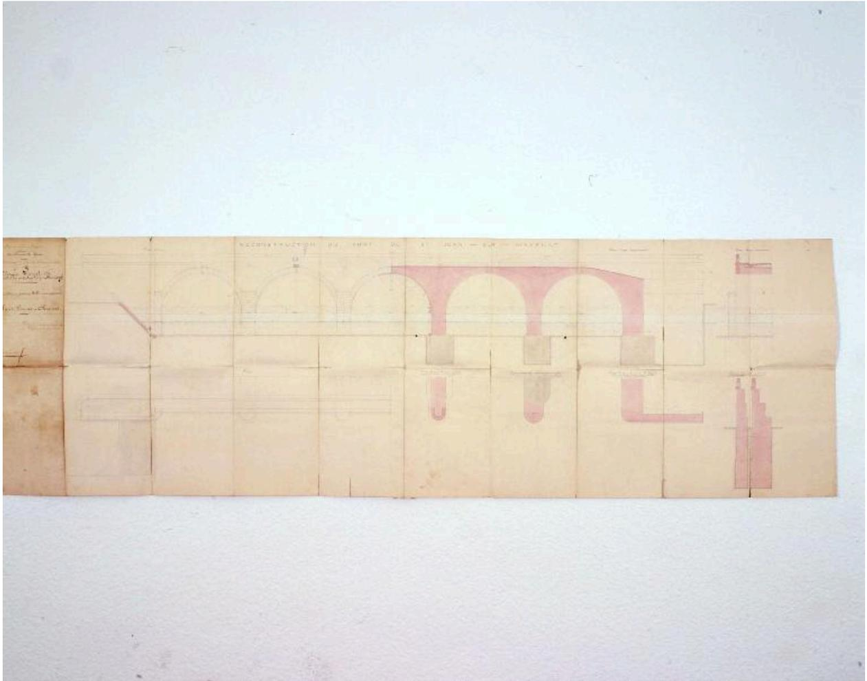
Projet de reconstruction (réalisé). Demi-élévation, demi-coupe longitudinale, plan, coupe des piles.
