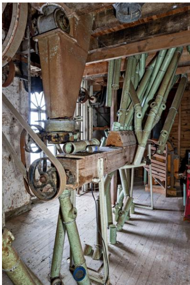
Deuxième étage, partie nord vue depuis l'ouest : l'ensacheur récupérant la farine venant du filtre à air situé au-dessus et les conduites pneumatiques reliant les broyeurs au plansichter. Phot. Yves Guillotin IVR52_20205300008NUCA
