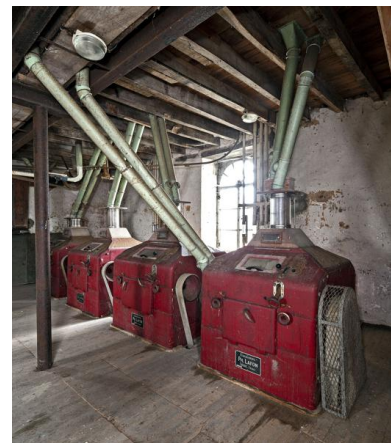
Premier étage, partie nord vue depuis le sud-est : les broyeurs à cylindres. Phot. Yves Guillotin IVR52_20205300052NUCA
