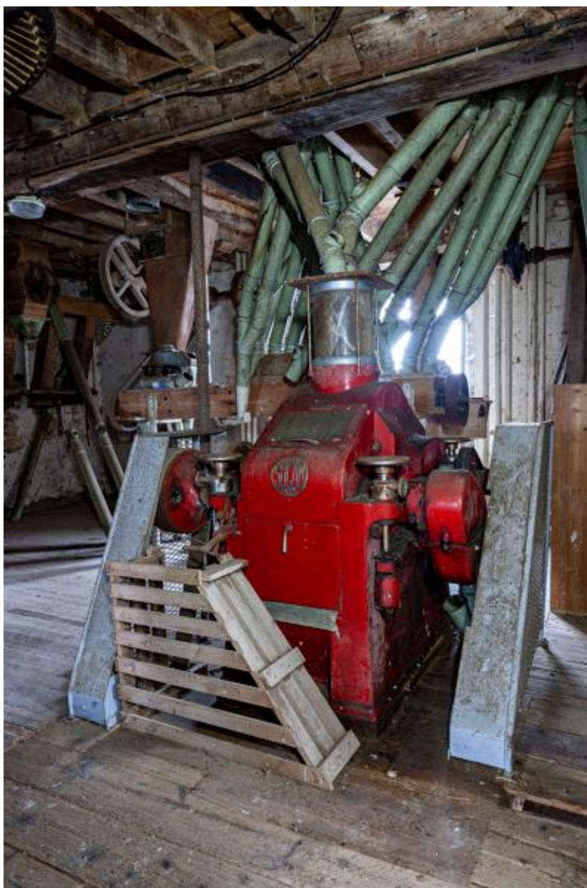
Deuxième étage, partie nord-est vue depuis le sud-est : paire de broyeurs à cylindres, de la marque SOCAM, installée dans les années 1970.
