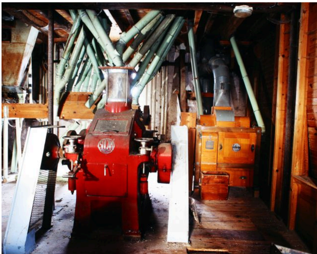
Deuxième étage, partie nord-est vue depuis le sud en 2002 : broyeur à cylindres de la marque SOCAM et brosse à blé de la marque Cesbron.
