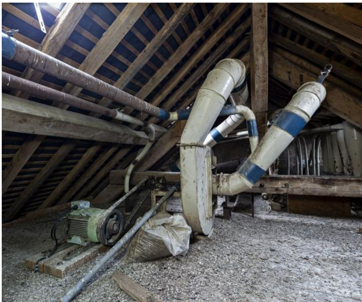
Comble, partie nord vue depuis le sud : soufflerie du système pneumatique. Elle est actionnée par un moteur de la marque CEM (Cie électro-mécanique) : moteur asynchrone n°7563993, METT 132MH4.
