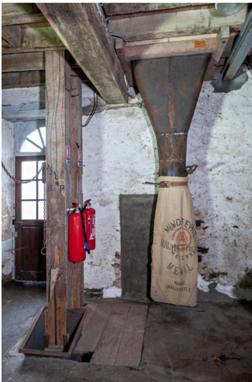
Rez-de-chaussée, partie sud vue depuis le nord : un des ensacheurs à farine et l'élévateur utilisé jusque dans les années 1970 pour le blé, amené en sacs et vidé dans la trémie située à sa base, puis pour l'orge.
