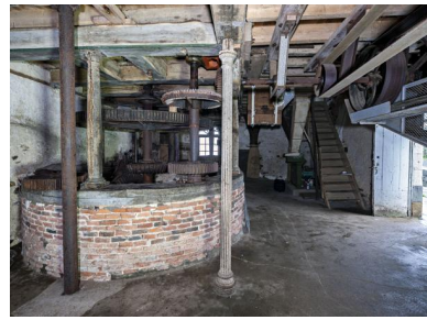
Rez-de-chaussée, partie sud vue depuis le nord. Au premier plan, la poquerie contenant le système de transmission du moulin. Au fond, à droite, un des ensacheurs à farine d'orge et le broyeur à marteau pour l'orge. Phot. Yves Guillotin IVR52_20205300062NUCA
