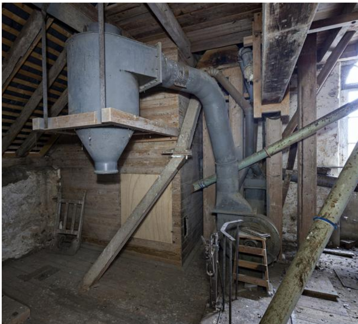
Étage en surcroît, partie sud-est vue depuis le nord : la chambre à blé sale et le récupérateur de poussière.
