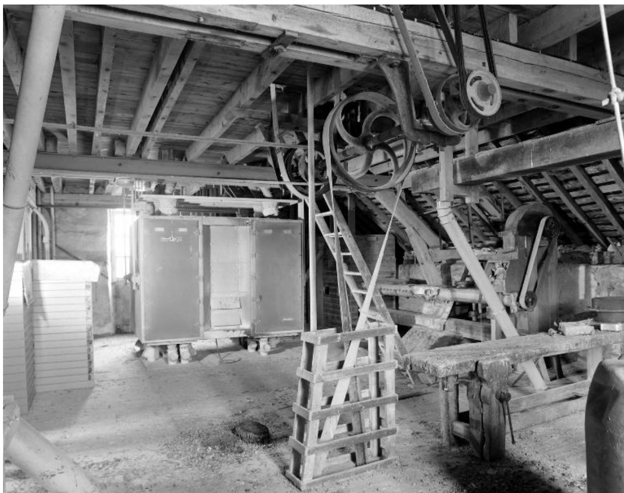
Etage en surcroît, partie nord, en 2002 : le plansichter de la marque Schneider, Jaquet et Cie, installé en 1976, le mouilleur à blé et la chambre à blé propre. Au premier plan, les courroies actionnant le monte-sac.
