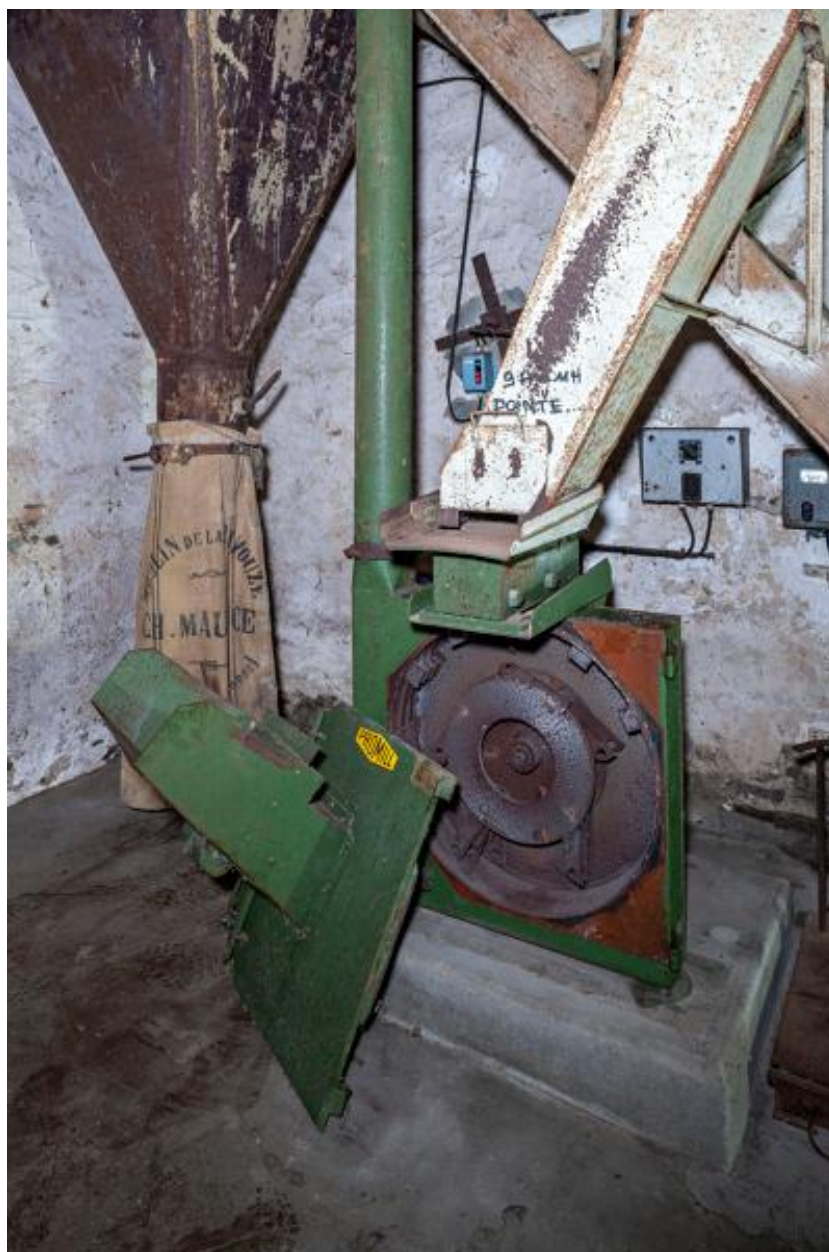
Rez-de-chaussée, partie sud-ouest vue depuis l'est : un des ensacheurs à farine d'orge et le broyeur à marteau utilisé pour l'orge.
