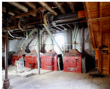
Premier étage, partie nord vue depuis le sud-est, en 2002 : les broyeurs à cylindres de la marque Ph. Lafon, installés en 1958. Phot. François Lasa IVR52_20025300224XA
