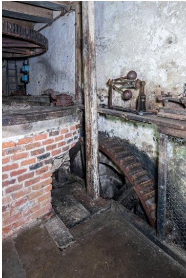
Rez-de-chaussée : le rouet de fosse, situé à l'extrémité de l'arbre de la roue hydraulique, vu depuis le sud-ouest. Au-dessus, le régulateur de vitesse provenant d'un autre moulin situé dans l'est de la France. Phot. Yves Guillotin IVR52_20205300034NUCA
