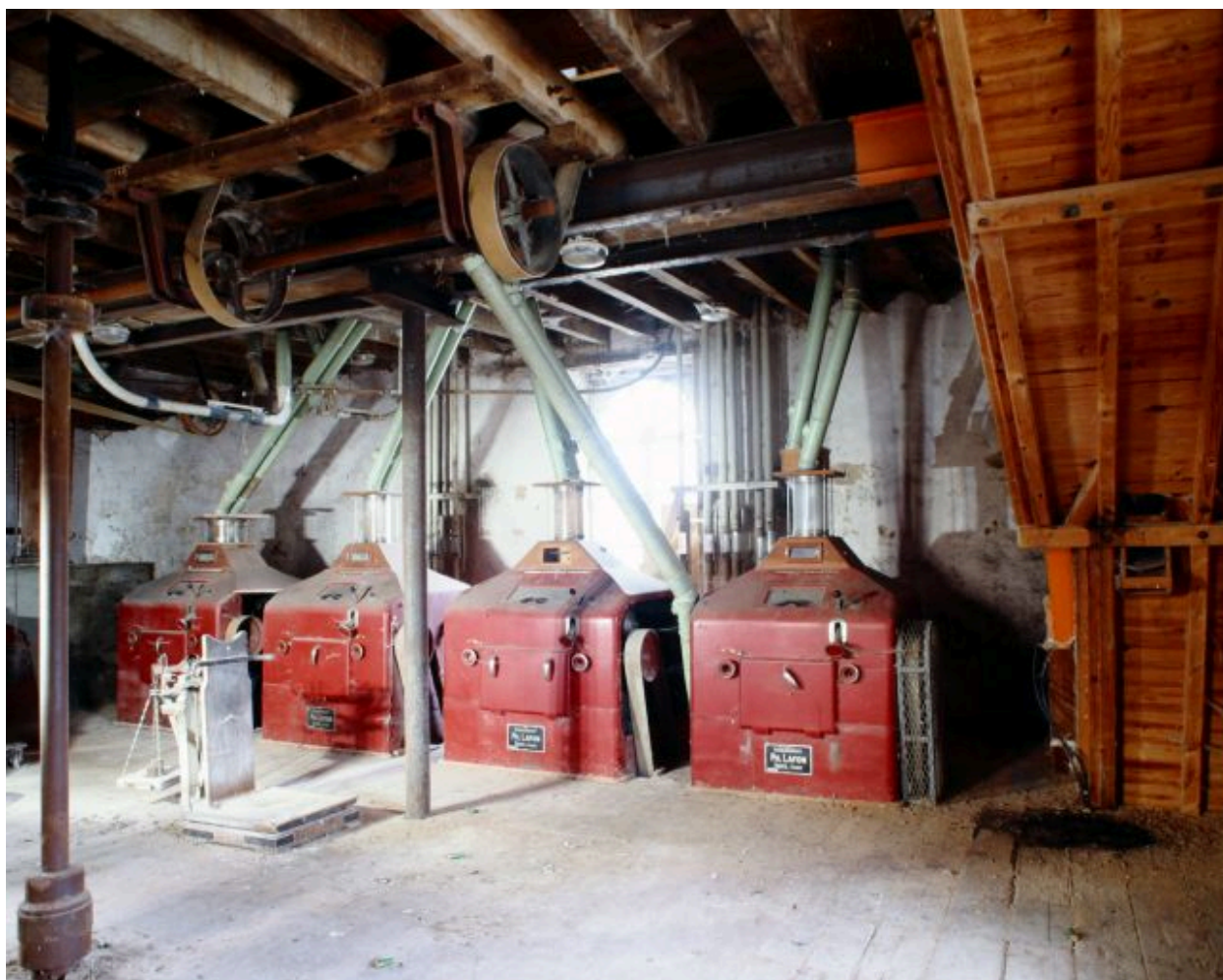
Premier étage, partie nord vue depuis le sud-est, en 2002 : les broyeurs à cylindres de la marque Ph. Lafon, installés en 1958.
