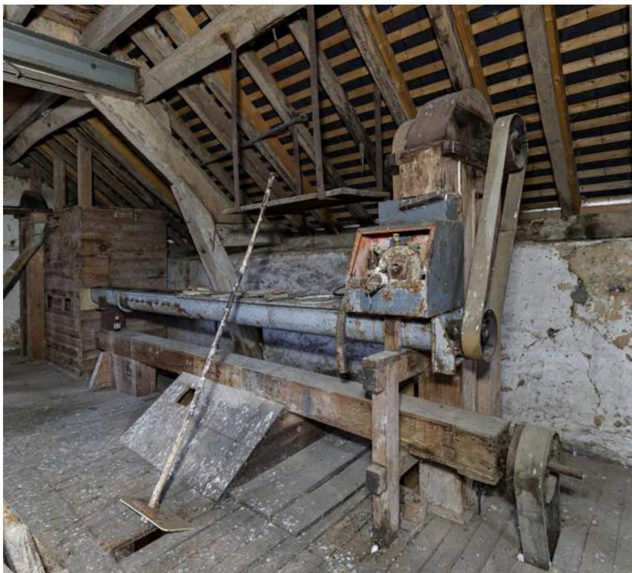
Étage en surcroît, partie est vue depuis le sud-ouest : le mouilleur à blé, avec sa vis sans fin, et l'élévateur qui y est adossé. A l'autre extrémité, la chambre à blé propre.
