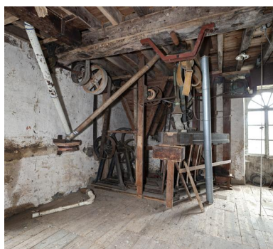
Premier étage, partie sud-est vue depuis le nord : l'épierreux et, au fond, la chambre à blé sale. Phot. Yves Guillotin IVR52_20205300054NUCA
