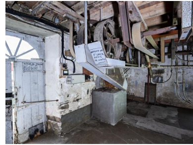
Rez-de-chaussée, partie nord-ouest vue depuis le sud : le moteur et les courroies transmettant le mouvement issu de la roue hydraulique et de ce moteur aux broyeurs à cylindres. Phot. Yves Guillotin IVR52_20205300059NUCA
