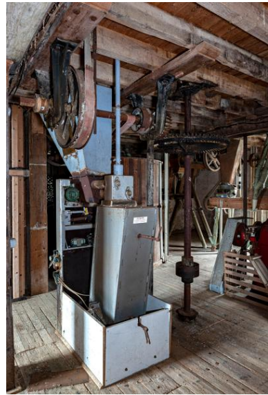
Deuxième étage, vue depuis le sud-est : partie supérieure de la peseuse-ensacheuse située à l'étage inférieur et installée en 1981. Phot. Yves Guillotin IVR52_20205300015NUCA
