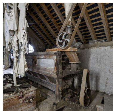
Étage en surcroît, partie nord-ouest : la bluterie à son vue depuis le nord-est.
