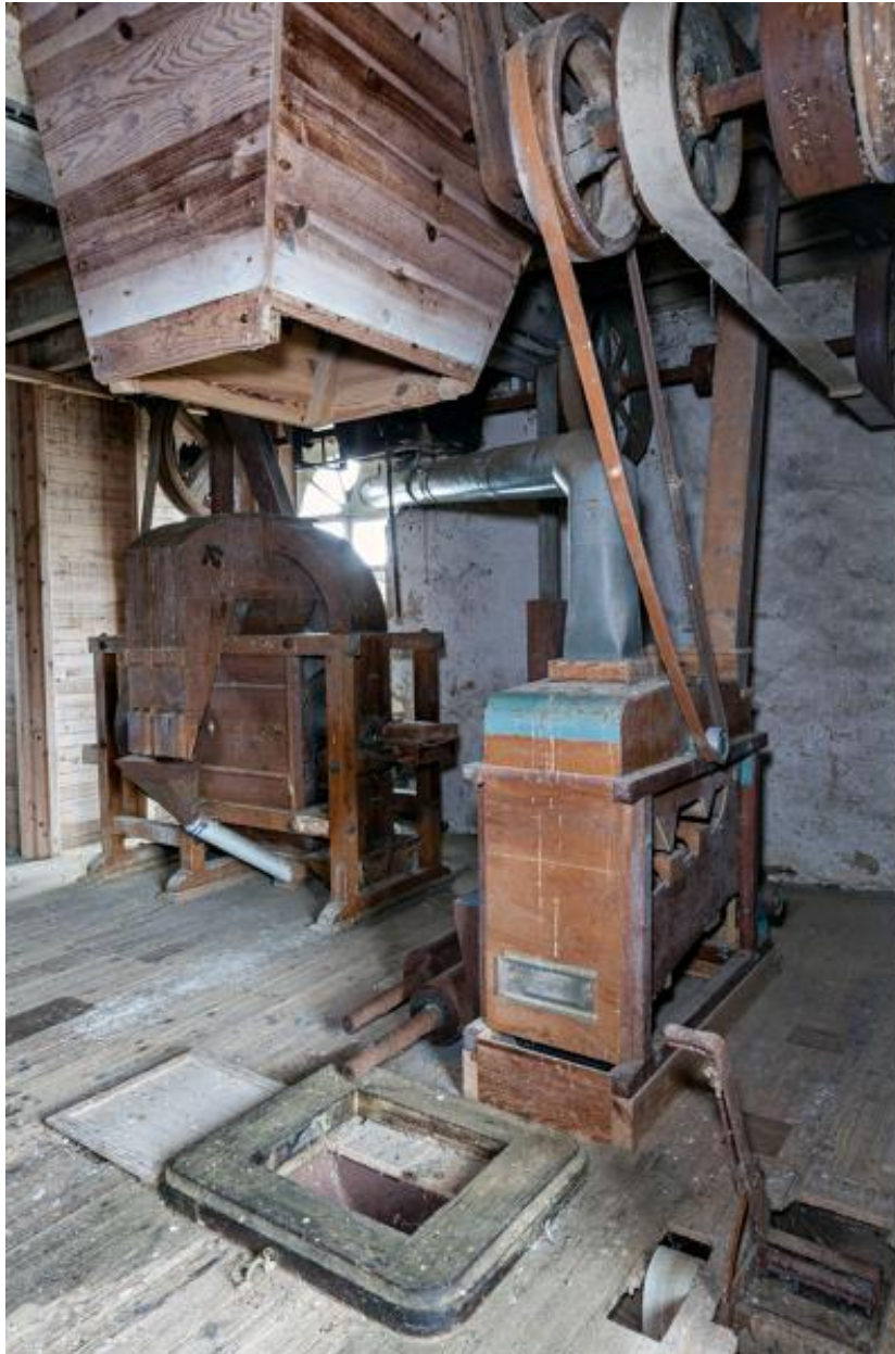
Deuxième étage, partie sud-est vue depuis le sud-ouest : le nettoyage à blé et le séparateur à blé. Au premier plan, emplacement de l'ancien broyeur déplacé à l'étage inférieur et ayant servi d'aplatisseur à la fin de l'activité du moulin.
