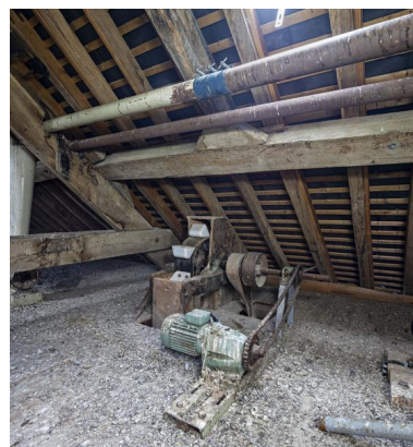
Comble, partie sud vue depuis le nord : les parties supérieures des deux élévateurs sud, la chaîne et la poulie du monte-sac. Phot. Yves Guillotin IVR52_20205300038NUCA
