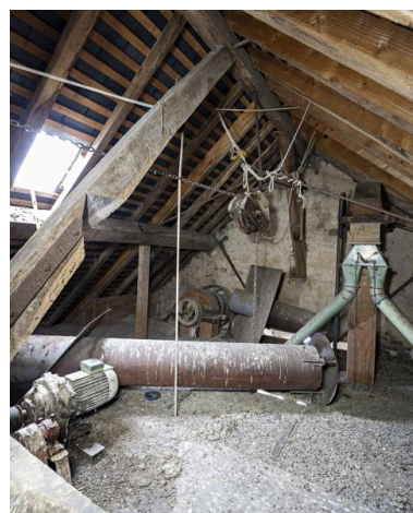
Comble, partie sud vue depuis le nord : les parties supérieures des deux élévateurs sud, la chaîne et la poulie du monte-sac. Phot. Yves Guillotin IVR52_20205300038NUCA
