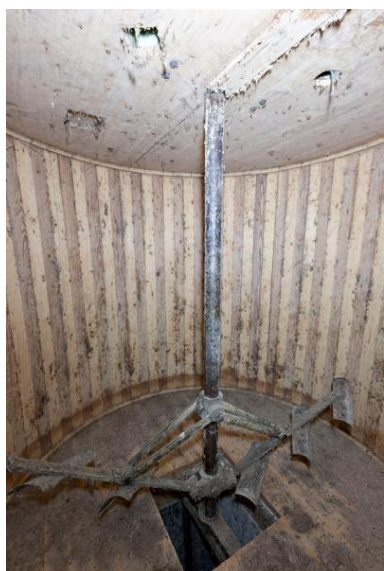
Deuxième étage : l'intérieur de la chambre à farine utilisée jusqu'au début des années 1980. Phot. Yves Guillotin IVR52_20205300018NUCA
