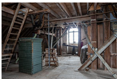
Étage en surcroît, partie sud vue depuis le nord-ouest : au premier plan, les tiroirs provenant du plansichter et la chambre à farine installée en 1981 ; à l'arrière-plan, la chambre à blé sale et la chaîne du monte-sac. Phot. Yves Guillotin IVR52_20205300005NUCA
