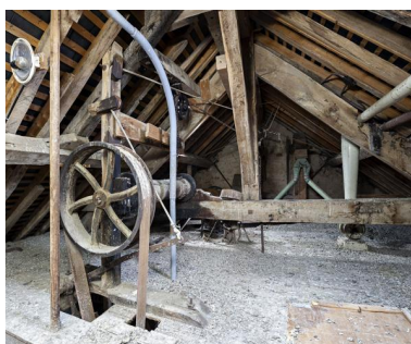
Comble, partie sud vue depuis le nord : le monte-sac. Phot. Yves Guillotin IVR52_20205300039NUCA
