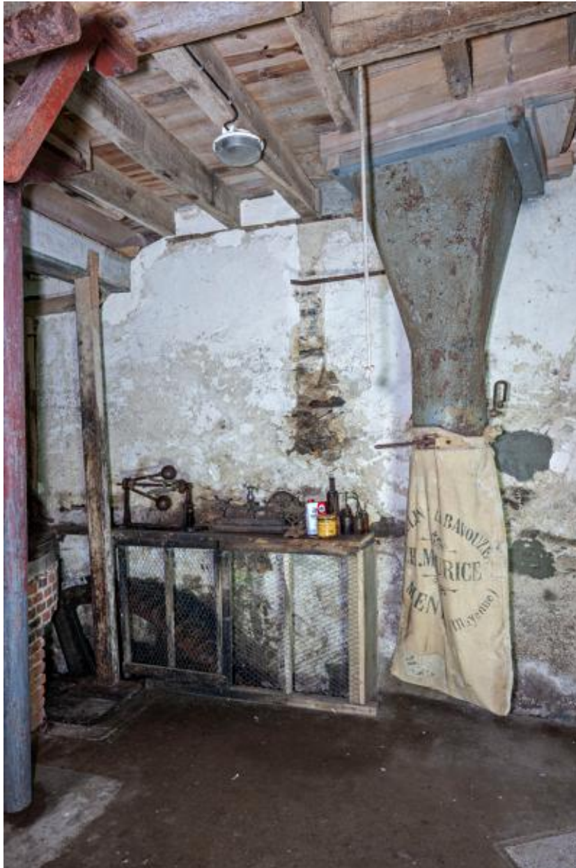
Rez-de-chaussée, partie sud-est vue depuis l'ouest : l'ensacheur qui recevait la mouture de l'aplatisseur qui se trouvait juste au-dessus.
