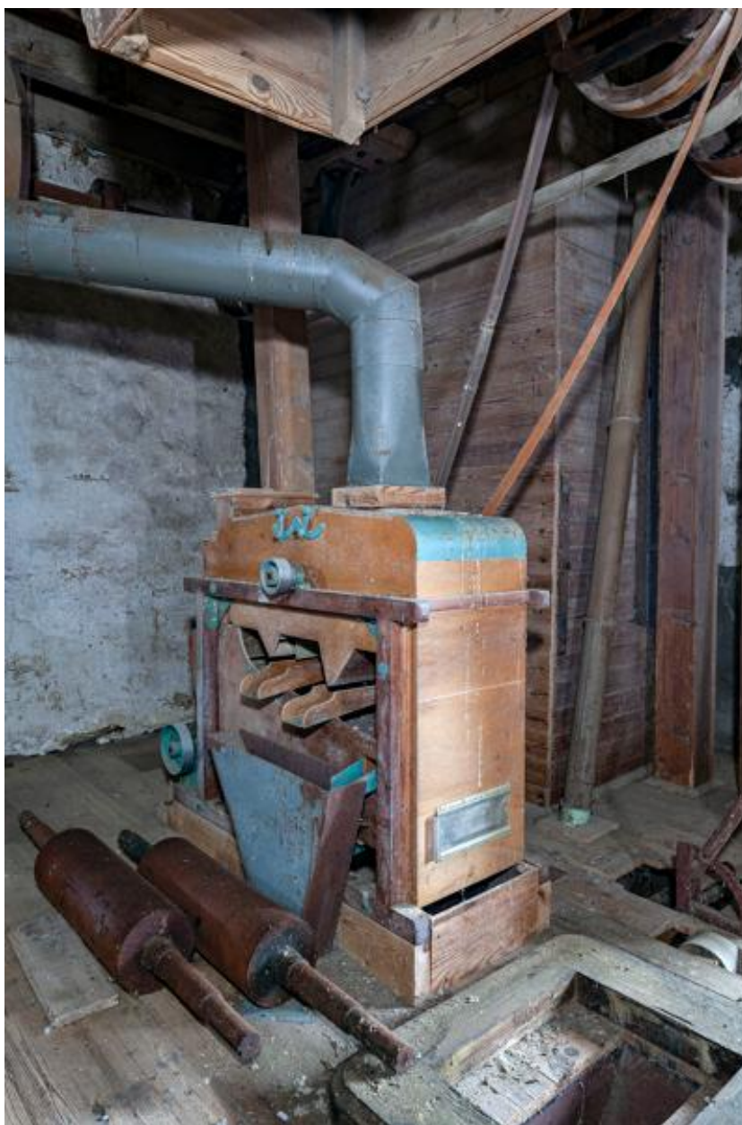
Deuxième étage, partie sud-est : le séparateur à blé et la chambre à blé sale vus depuis le nord-ouest
