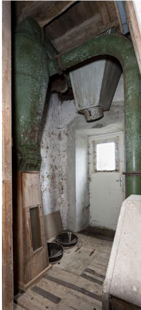
Premier étage, angle sud-ouest : la mélangeuse de farine à orge.
