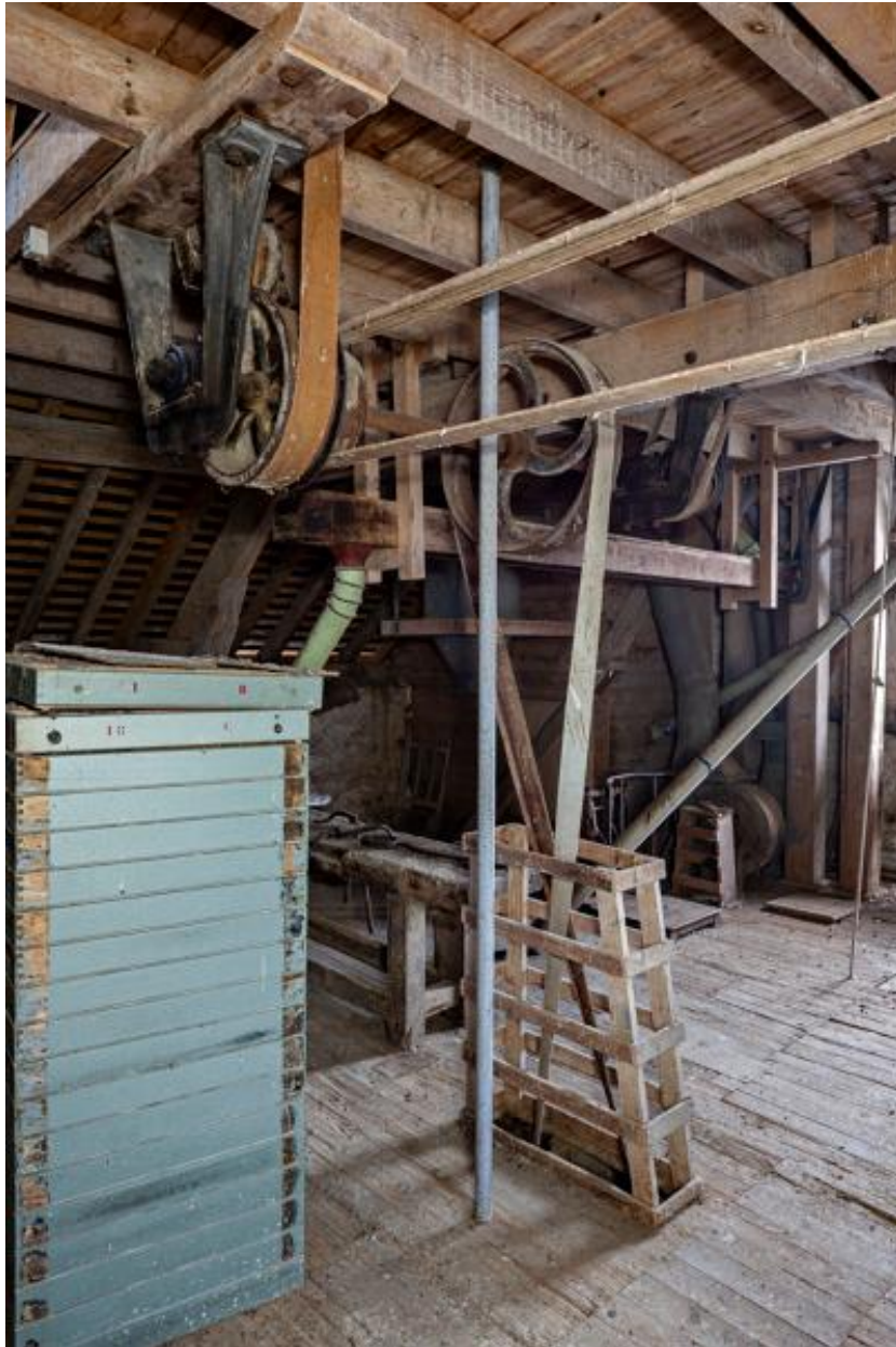
Étage en surcroît, partie sud-est vue depuis le nord-ouest : tiroirs provenant du plansichter et, au-dessus, courroies actionnant le monte-sac.
