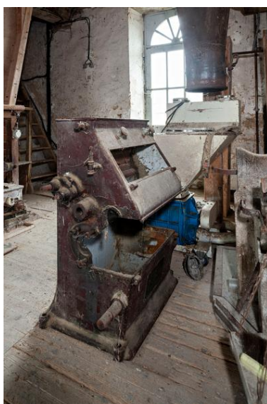
Premier étage, partie ouest : broyeur de la marque Lafon, acheté d'occasion vers 1975 près de Tours, et qui a été déplacé du deuxième étage. Phot. Yves Guillotin IVR52_20205300022NUCA
