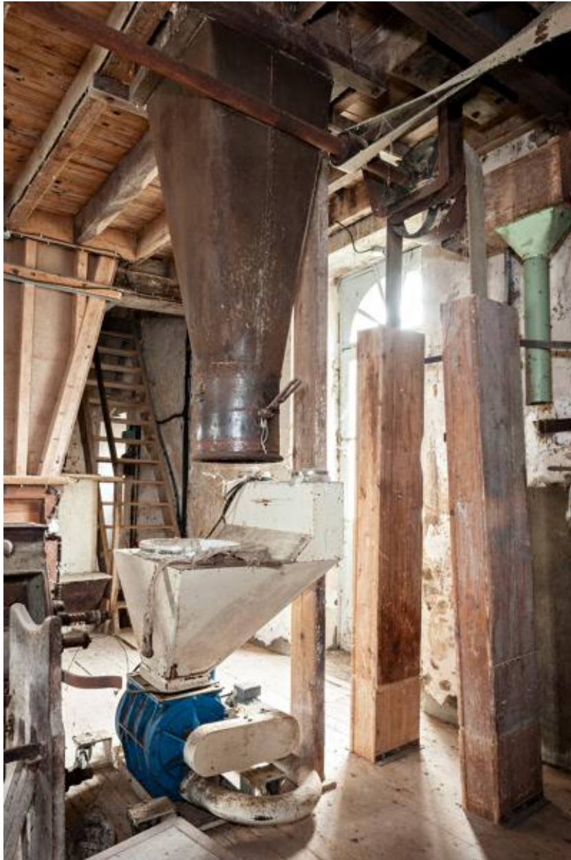
Premier étage, partie sud-ouest vue depuis le nord-est : au premier plan, l'ensacheur à farine de blé qui a fonctionné jusqu'au début des années 1980 et dans lequel tombait la farine stockée dans la chambre ronde située au-dessus.
