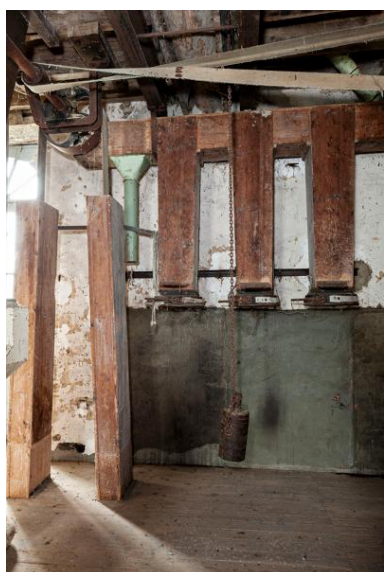
Premier étage, partie nord-ouest : les trois ensacheurs à son et à recoupe ou remoulage vus depuis l'est. Phot. Yves Guillotin IVR52_20205300019NUCA
