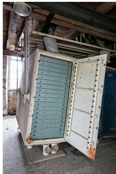
Étage en surcroît, partie nord : la partie gauche du plansichter vue depuis le sud.
