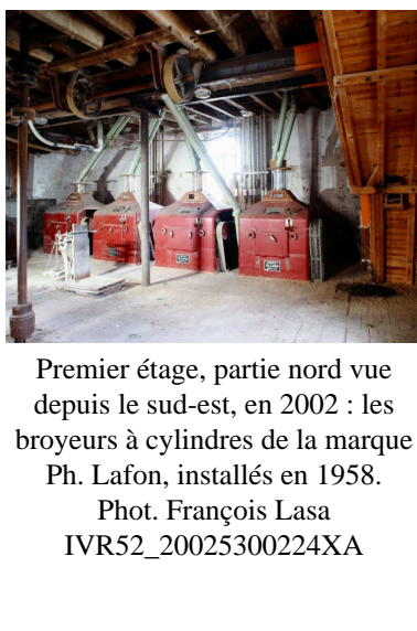
Premier étage, partie nord vue depuis le sud-est : les broyeurs à cylindres. Phot. Yves Guillotin IVR52_20205300052NUCA
