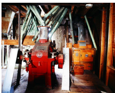
Deuxième étage, partie nord-est vue depuis le sud en 2002 : broyeur à cylindres de la marque SOCAM et brosse à blé de la marque Cesbron. Phot. François Lasa IVR52_20025300227XA
