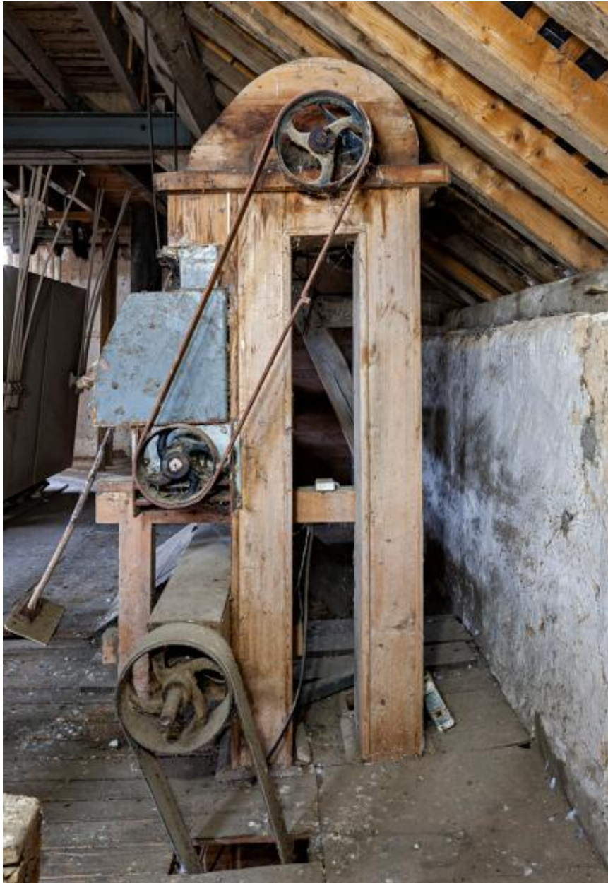
Étage en surcroît, partie est : l'élévateur accolé au mouilleur à blé vu depuis le sud. Il remontait le grain depuis le nettoyeur situé au deuxième étage.
