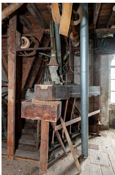
Premier étage, partie sud-est vue depuis le nord : l'épierreur et, au fond, la chambre à blé sale. Le blé était ensuite remonté par les élévateurs jusqu'au nettoyeur situé au deuxième étage. Phot. Yves Guillotin IVR52_20205300024NUCA
