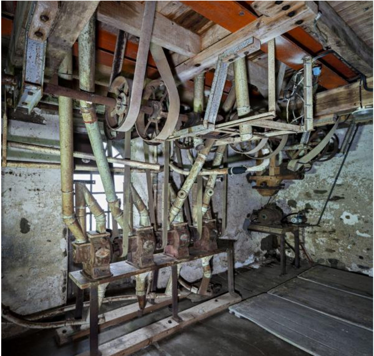
Rez-de-chaussée, partie nord vue depuis le sud-ouest : les conduites pneumatiques permettant la remontée de la mouture issue des broyeurs vers le plansichter. Au fond, dans l'angle, le moteur d'appoint de la roue.
