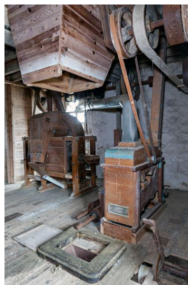
Deuxième étage, partie sud-est vue depuis le sud-ouest : le nettoyage à blé et le séparateur à blé. Au premier plan, emplacement de l'ancien broyeur déplacé à l'étage inférieur et ayant servi d'aplatisseur à la fin de l'activité du moulin. Phot. Yves Guillotin IVR52_20205300014NUCA
