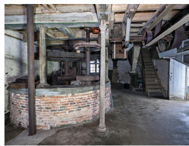
Rez-de-chaussée, partie sud vue depuis le nord. Au premier plan, la poquerie contenant le système de transmission du moulin. Au fond, à droite, un des ensacheurs à farine d'orge et le broyeur à marteau pour l'orge. Phot. Yves Guillotin IVR52_20205300062NUCA
