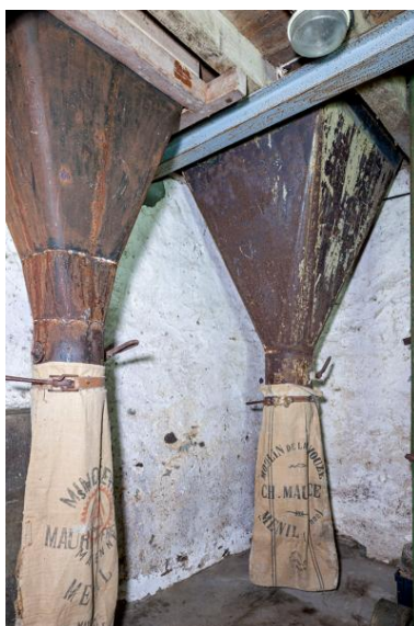
Rez-de-chaussée, partie sud-ouest : les ensacheurs à farine d'orge vus depuis le nord-est. Phot. Yves Guillotin IVR52_20205300032NUCA
