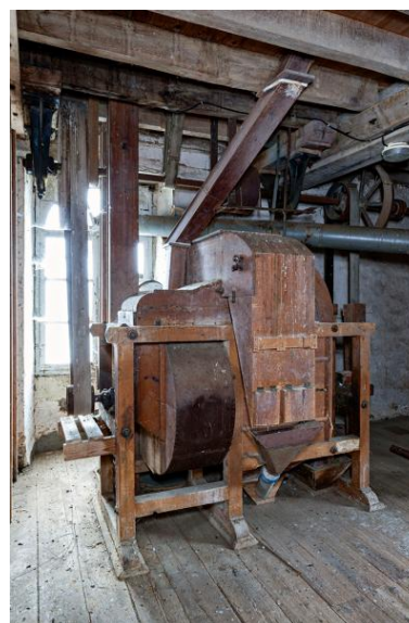
Deuxième étage, partie sud-est : le nettoyage à blé vu depuis l'ouest. Phot. Yves Guillotin IVR52_20205300012NUCA
