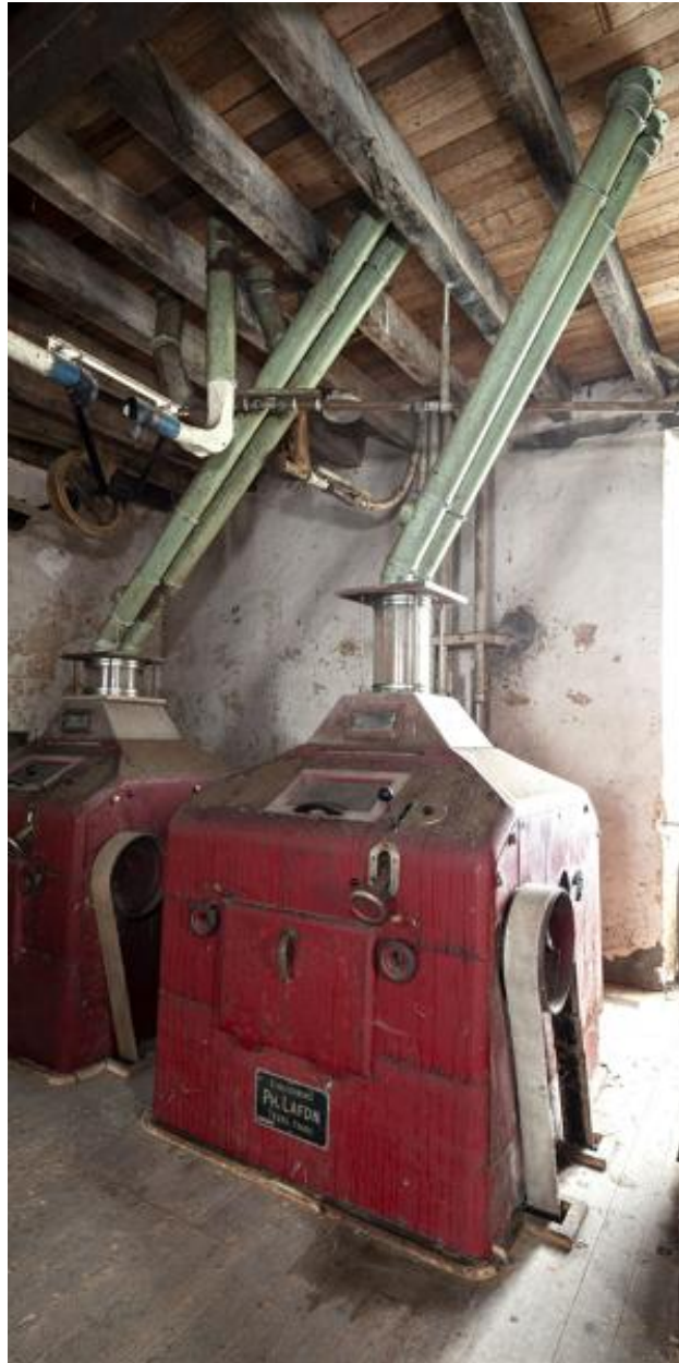
Premier étage, partie nord : deuxième broyeur à cylindres en partant de l'ouest.
