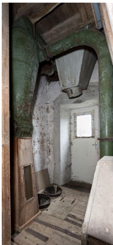
Deuxième étage, partie nord-est vue depuis le sud en 2002 : broyeur à cylindres de la marque SOCAM et brosse à blé de la marque Cesbron. Phot. François Lasa IVR52_20025300227XA
