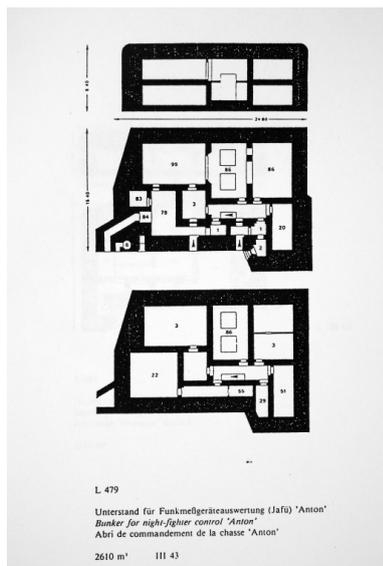
Plan d'un blockhaus de type L 479. Abri de commandement de la chasse Anton (2610 m<sup>3</sup>).
