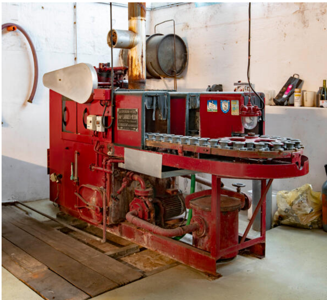
Laveuse à bouteilles dite "Girondine".
