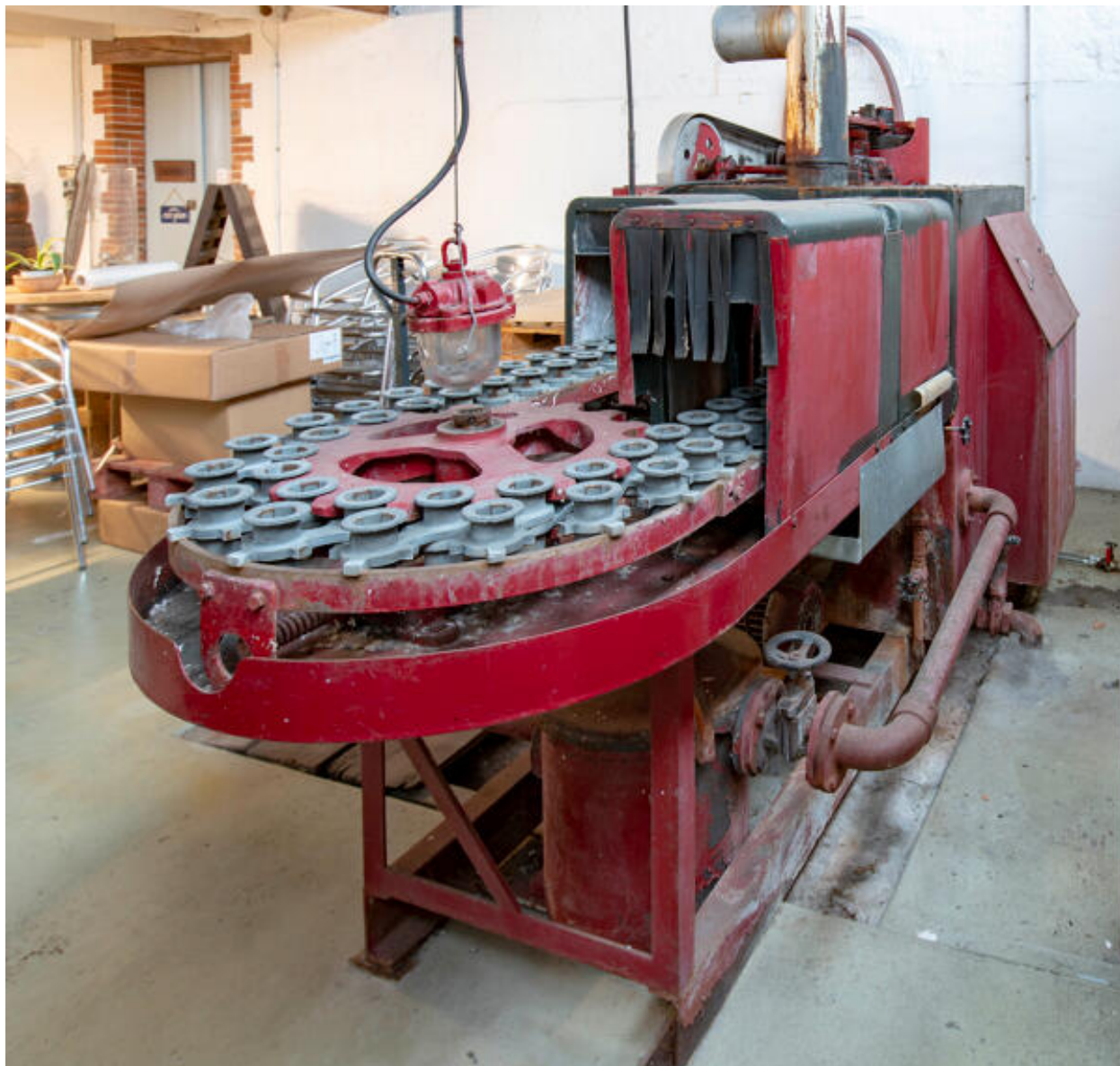
Laveuse à bouteilles dite "Girondine".
