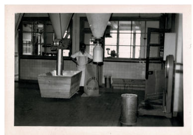
Ensachage de la poudre de lait sous la cuve d'atomisation, vers 1955. Repro. Yannis Suire IVR52_20238500317NUCA
