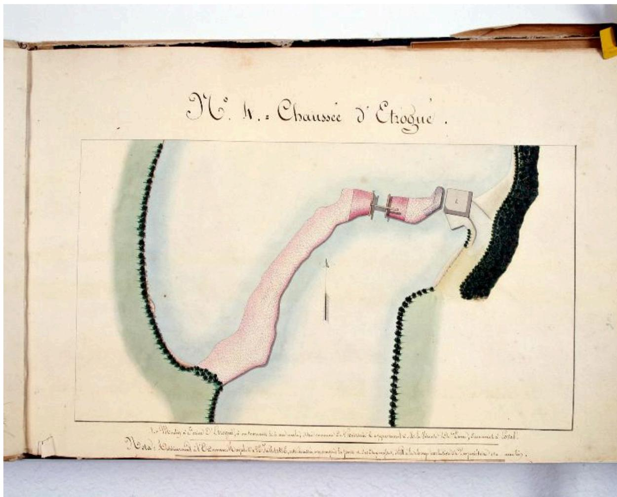
Planche N° 4 du recueil des plans des barrages de la partie navigable de la Mayenne. Plan d'ensemble du site d'Etrogné avant la canalisation de la rivière : barrage, porte marinière, moulin à farine.
