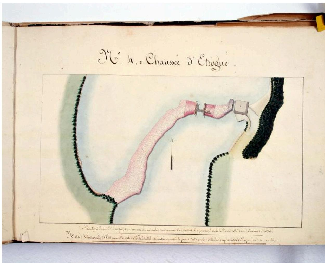
Planche N° 4 du recueil des plans des barrages de la partie navigable de la Mayenne. Plan d'ensemble du site d'Etrogne avant la canalisation de la rivière : barrage, porte marinière, moulin à farine.
