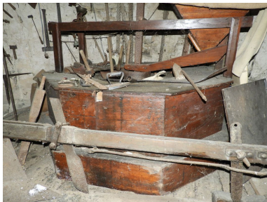
La paire de meules du premier étage, dans son coffre en bois. Phot. Yannis Suire IVR52_20188501138NUCA
