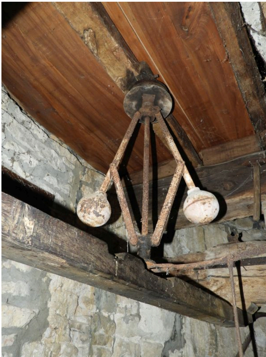
Le régulateur Watt, au premier étage.
