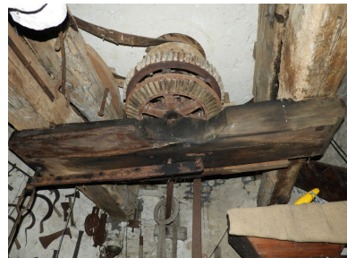
Le mécanisme sous la paire de meules du second étage. Phot. Yannis Suire IVR52_20188501137NUCA
