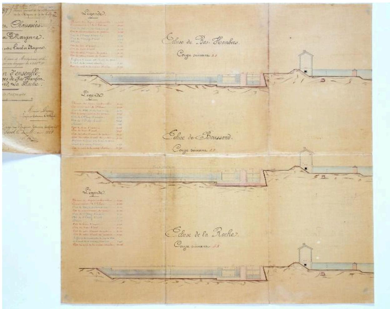
Projet de canalisation de la Mayenne entre le Bas-Hambert et Grenoux : coupes longitudinales des barrages de Bas-Hambert, Boussard et la Roche.
