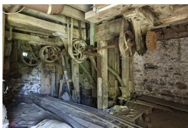
Rez-de-chaussée du moulin : vue depuis le sud-ouest de la fosse contenant la turbine, de l'axe horizontal et des courroies de transmission, des élévateurs à godets et conduites est.
