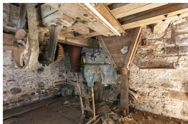
Rez-de-chaussée du moulin : vue depuis le sud des élévateurs à godets ouest, de l'élévateur nord et de l'ensacheur à aplati.
