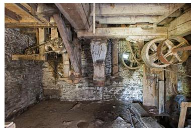
Rez-de-chaussée du moulin : vue depuis le sud de l'élévateur à godets nord et de l'ensacheur à aplati. A droite, l'axe horizontal et les courroies de transmission.
