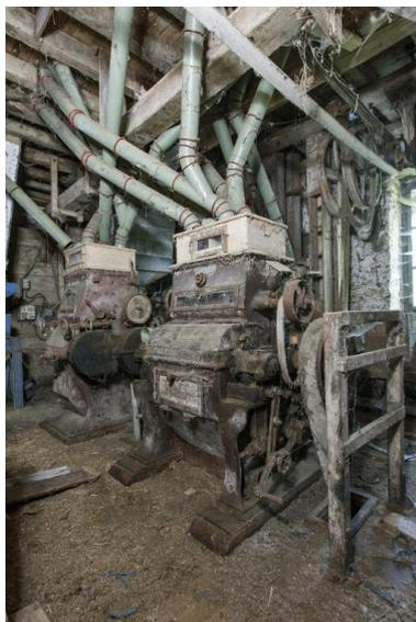
Rez-de-chaussée du moulin : vue depuis le nord-ouest des ensacheurs à farine. A gauche, l'axe horizontal et les courroies de transmission.
