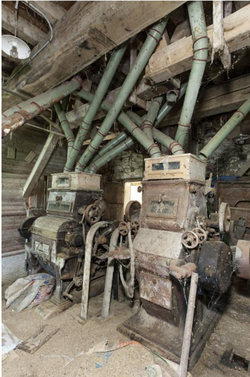
Premier étage du moulin : vue depuis le nord-est des broyeurs à cylindres.
