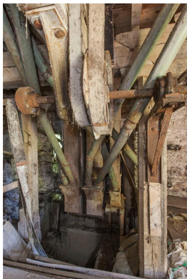
Rez-de-chaussée du moulin, vue d'ensemble depuis le sud-ouest : élévateurs à godets ouest, axe horizontal et courroies de transmission de la force motrice, un des ensacheurs à farine. Phot. Yves Guillotin IVR52_20185300407NUCA
