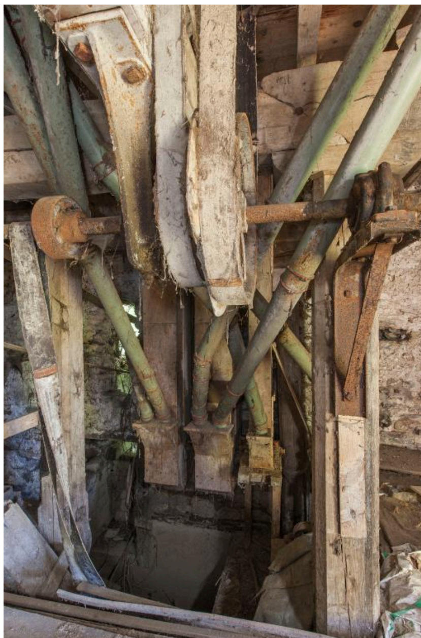
Rez-de-chaussée du moulin : vue partielle de la fosse contenant la turbine, de l'axe horizontal et des courroies de transmission, des élévateurs et des conduites est.
