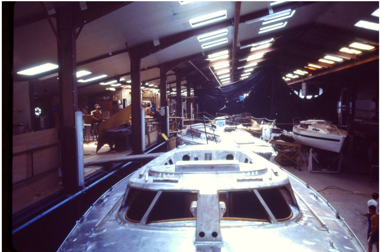
Bateaux en aluminium en construction au chantier naval Pouvreau vers 1980.
