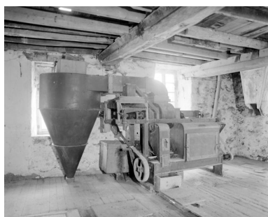
Machine à séparer l'écorce du grain. Phot. François Lasa IVR52_20015300600X
