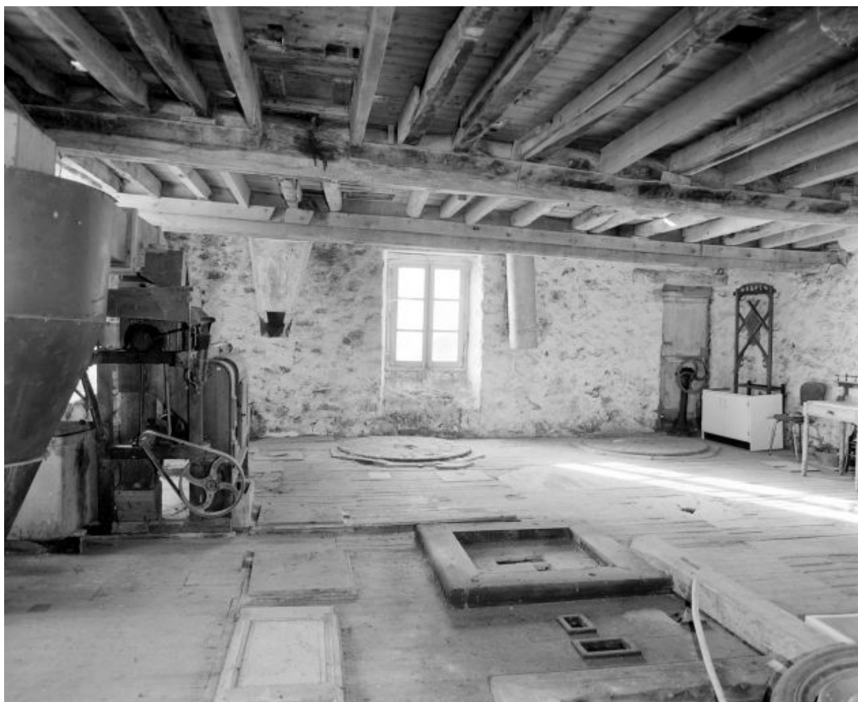
Le premier étage du moulin, vu vers l'ouest. A gauche, machine à séparer le grain de l'écorce. Au premier plan, trace au sol des machines à cylindres. Au fond, emplacement des deux meules.
