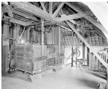
Comble du moulin. Le plansichter. Phot. François Lasa IVR52_20015300602X
