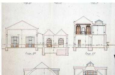
Usine Hamard : coupe longitudinale sur le bâtiment des machines dans la cour et coupe transversale sur le bâtiment d'entrée (porche, conciergerie et appartement) dans l'angle sud-ouest de la cour. Extrait d'un document général de l'usine, dessin, 1906.
