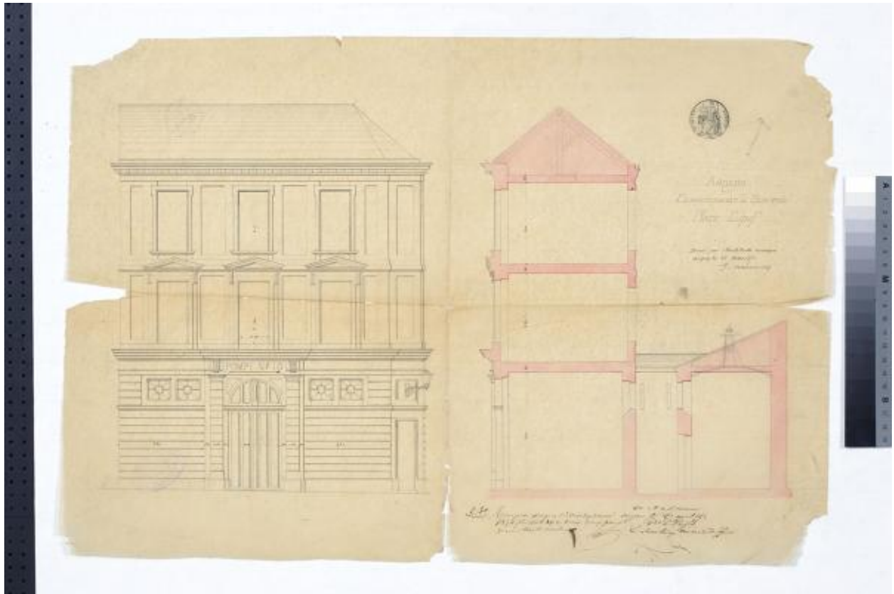
Angers. Commissariat de quartier Place Cupif : élévation sur la rue Millet et coupe (second projet sans entresol, réalisé), par E. Dainville, 1870. (Archives municipales d'Angers ; 40 M 4).
