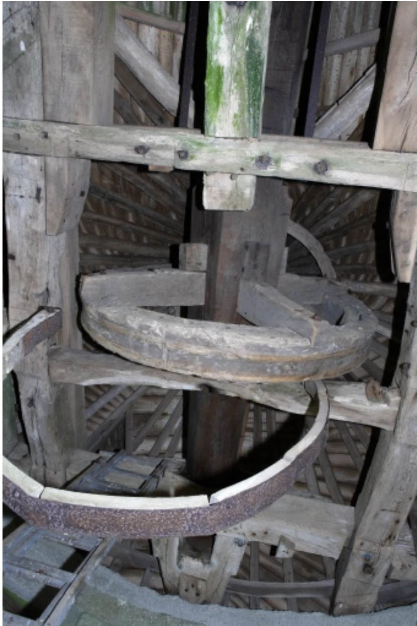
Vue intérieure de la coiffe ; l'arbre moteur, le rouet et la bande du frein.
