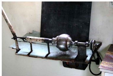
Appareil pour astiquer les boules inventé par Gérard Maximil. Phot. Jean-Baptiste Darrasse IVR52_20067206827NUCA
