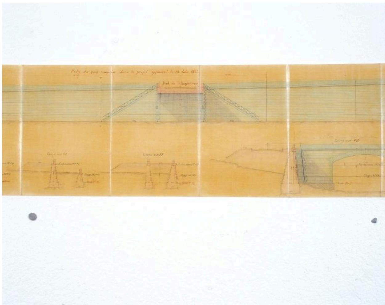
Projet du quai rive droite. Elévation du nord (pont neuf) au sud (écluse) et coupes, quatrième partie.
