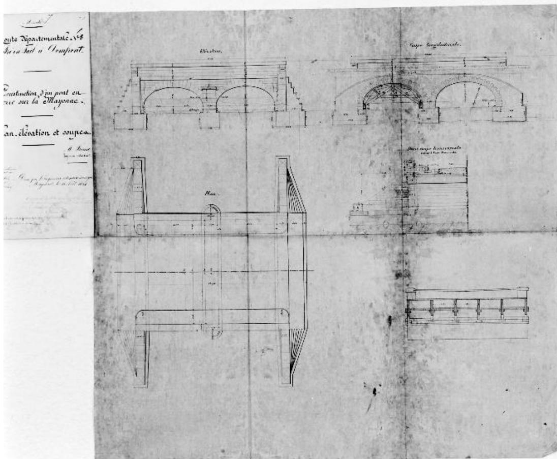
Projet de reconstruction (réalisé) : élévation, plan, coupes.
