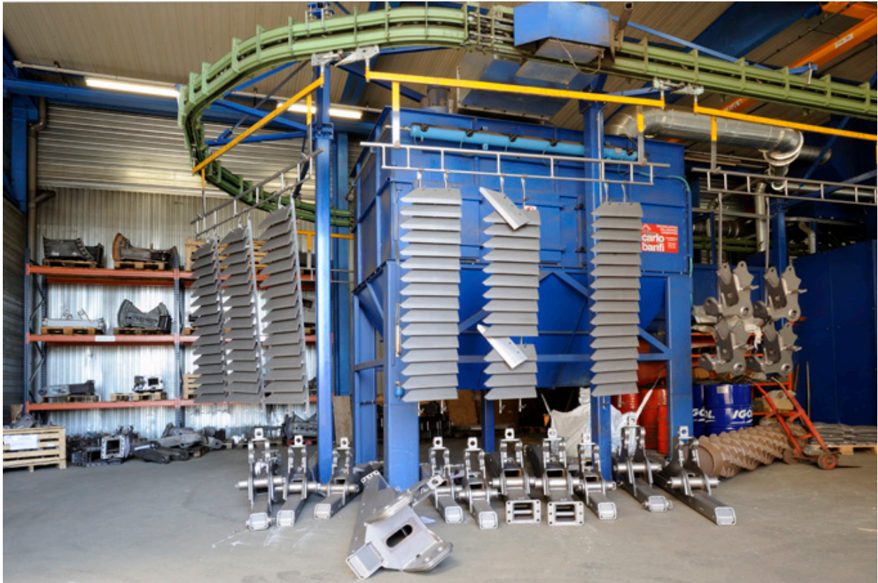
Usine Grégoire-Besson : atelier pour le grenailage.
