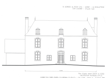
Relevé de l'élévation antérieure du logis en 1999, avant restauration. A noter l'état ancien de la lucarne droite.
