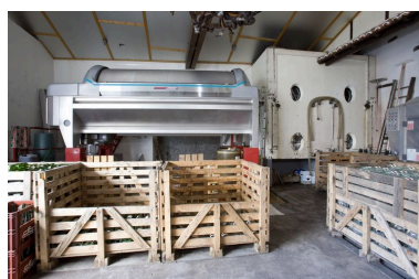
La dépendance est : la cuve aérienne en ciment datant des années 1950 et le pressoir pneumatique. Phot. Yves Guillotin IVR52_20104402986NUCA
