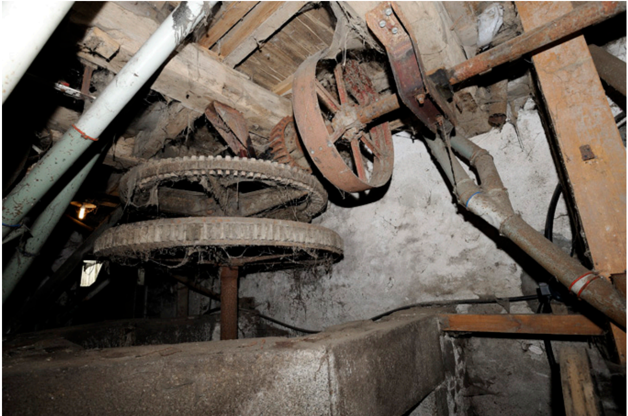
Le rouet de fosse et l'ensemble des rouages qui entraînent les trois paires de meules.
