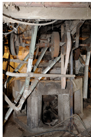
La rotonde, support au rouet de fosse et à l'ensemble des rouages. Phot. Bruno Rousseau IVR52_20114900814NUCA
