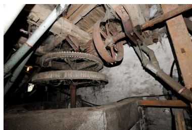
Le rouet de fosse et l'ensemble des rouages qui entraînent les trois paires de meules. Phot. Bruno Rousseau IVR52_20114900812NUCA
