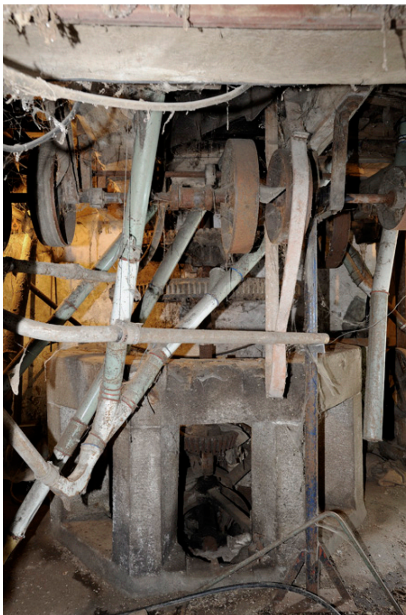
La rotonde, support au rouet de fosse et à l'ensemble des rouages.
