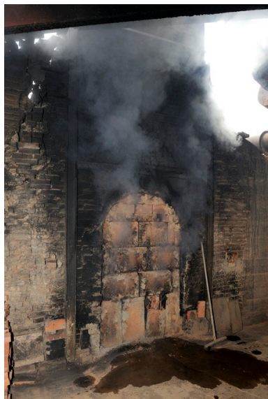
Porte du four à bois, murée après chargement des tuiles et briques.
