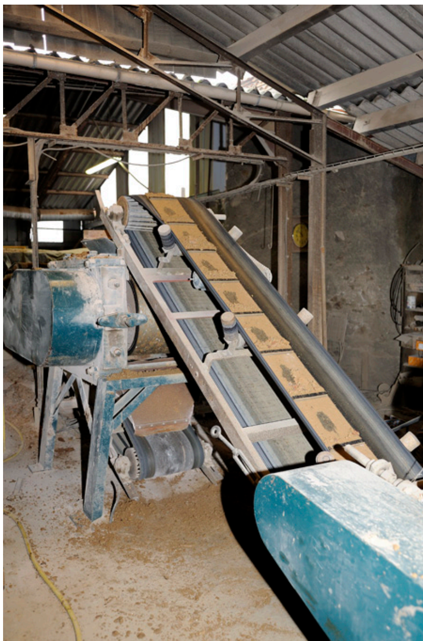
Cordon d'argile dirigé vers une matrice et la découpe, pour prendre sa forme définitive.
