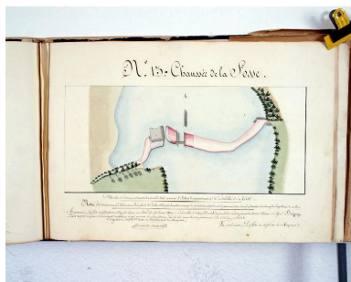
Planche n° 13 du recueil des plans des barrages de la partie navigable de la Mayenne. Plan d'ensemble du site de la Fosse avant la construction de l'écluse : barrage, porte marinière, moulin à farine. Autr. Louis-Xavier Deslandes de Lancelot, Repro. François Lasa IVR52_20015300178XA
