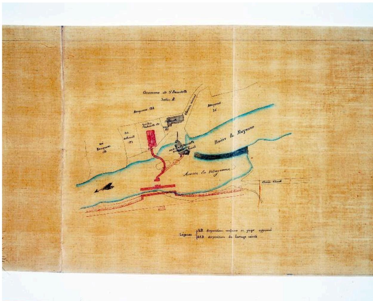
Plan d'ensemble : ancien barrage, nouveau barrage selon les dispositions approuvées en 1846 (non réalisé), barrage en cours d'exécution ; ancien moulin (détruit), moulin en construction.
