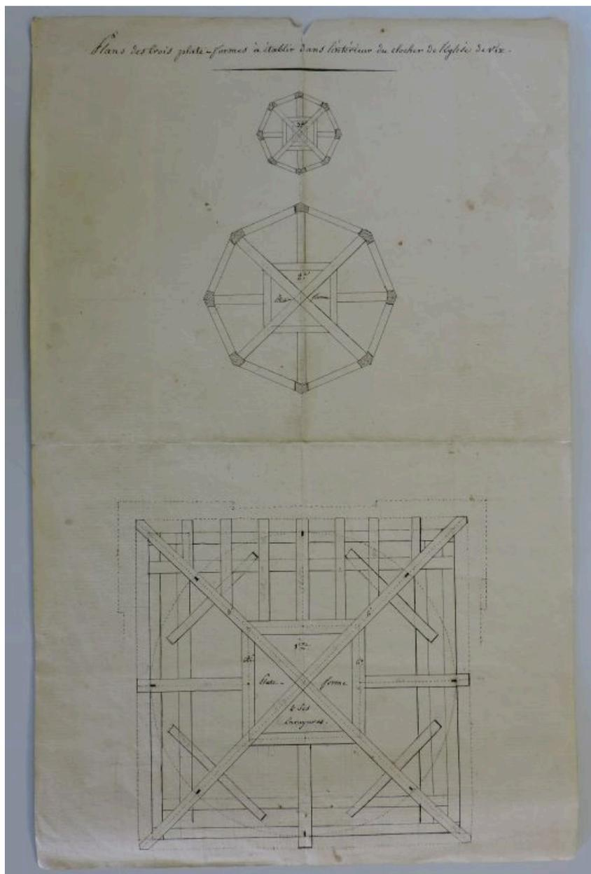
Projet de clocher à flèche par Périot, 14 juillet 1831 : plans des niveaux de la charpente.
