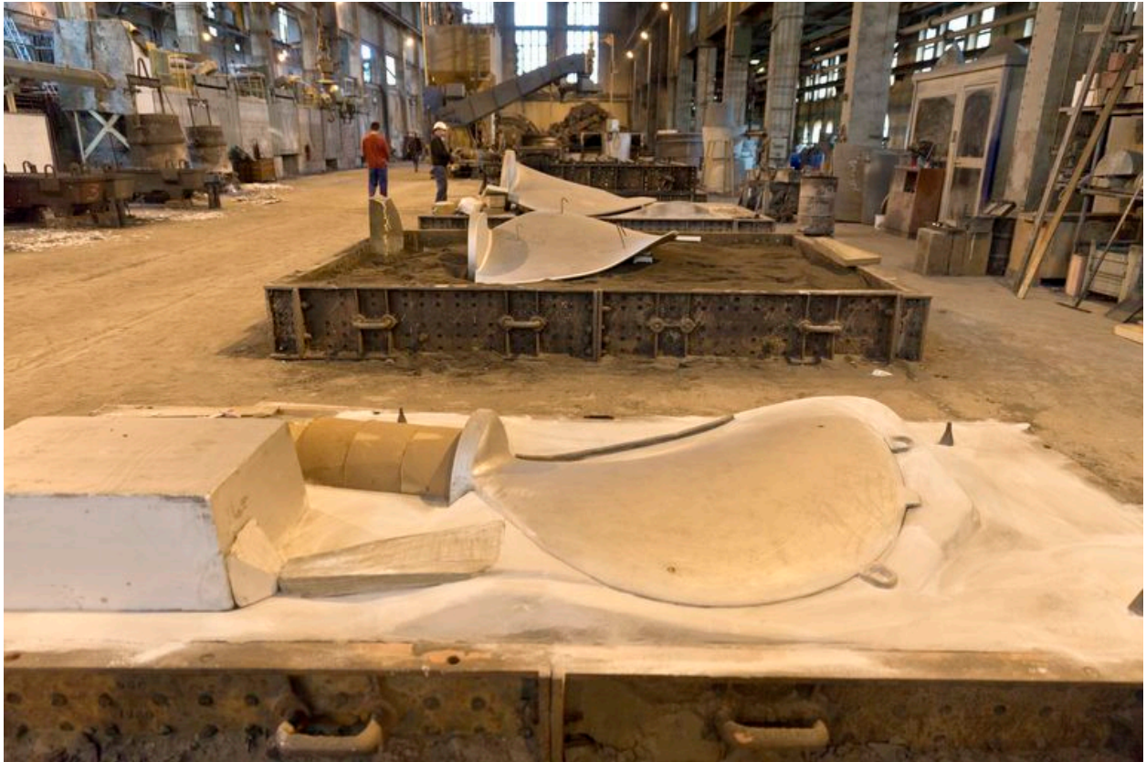
Décochage : séparation de la pièce du moule.
