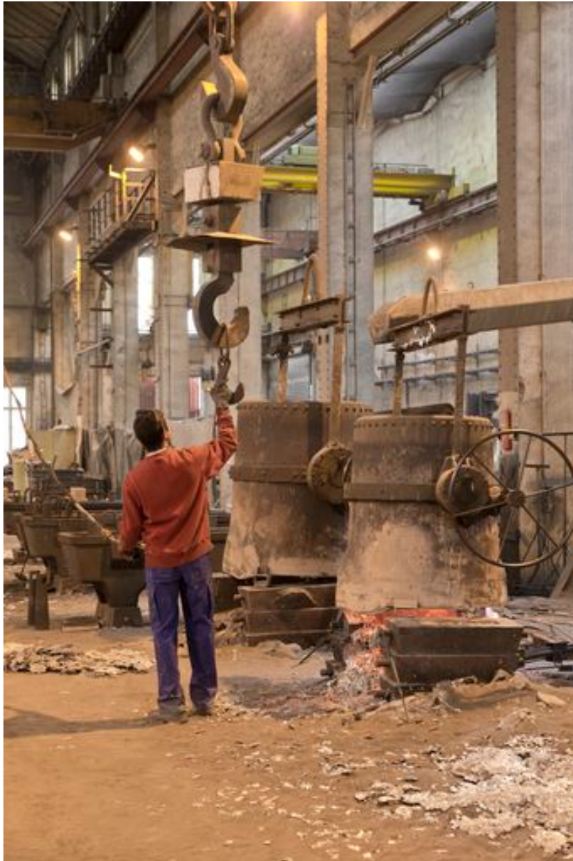
Préparation de la poche de coulée pour l'amener jusqu'au four.
