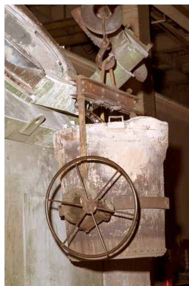
Remplissage de la poche de coulée d'aluminium fondu dans le four. Phot. Denis Pillet IVR52_20134401499NUCA
