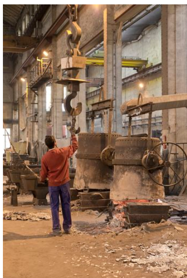
Préparation de la poche de coulée pour l'amener jusqu'au four. Phot. Denis Pillet IVR52_20134401497NUCA
