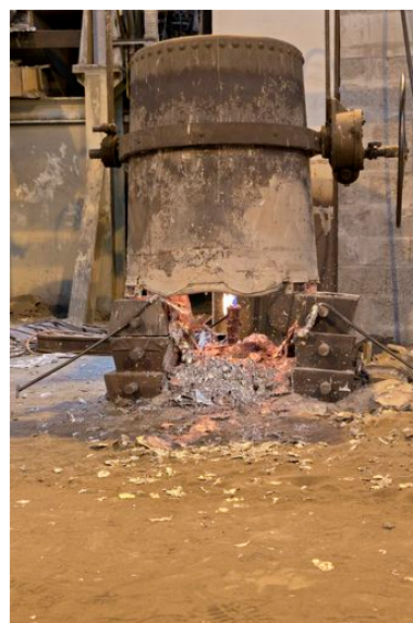
Poche de coulée en cours de chauffage. Phot. Denis Pillet IVR52_20134401495NUCA
