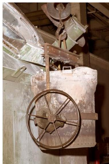
Remplissage de la poche de coulée d'aluminium fondu dans le four.
