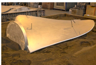
Décochage : séparation de la pièce du moule. Phot. Denis Pillet IVR52_20134401509NUCA
