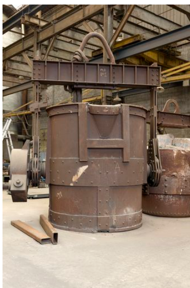
Poche de coulée conservée dans la chaufferie. Phot. Denis Pillet IVR52_20134401800NUCA
