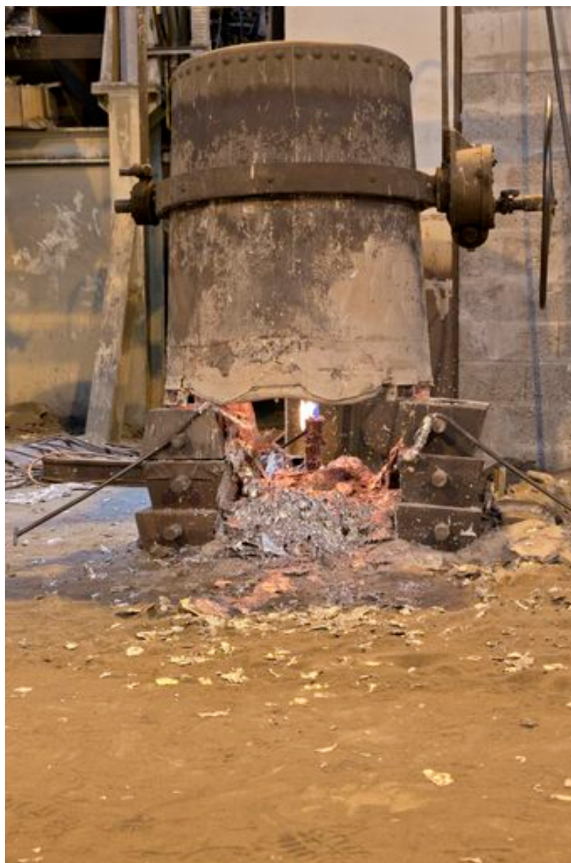
Poche de coulée en cours de chauffage.
