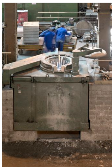
Remplissage du four de lingots d'aluminium pour la fonte. Phot. Denis Pillet IVR52_20134401791NUCA
