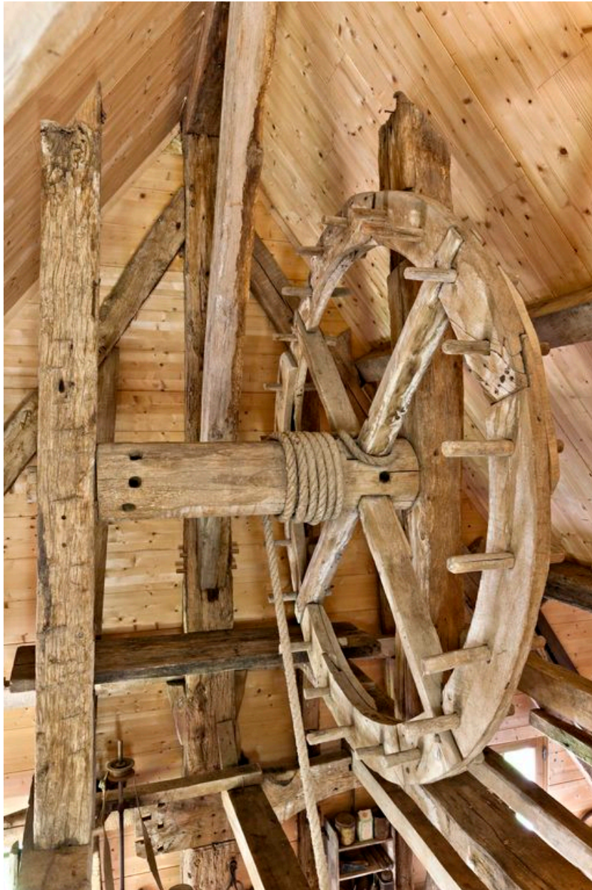
Détail du treuil à lever les meules
