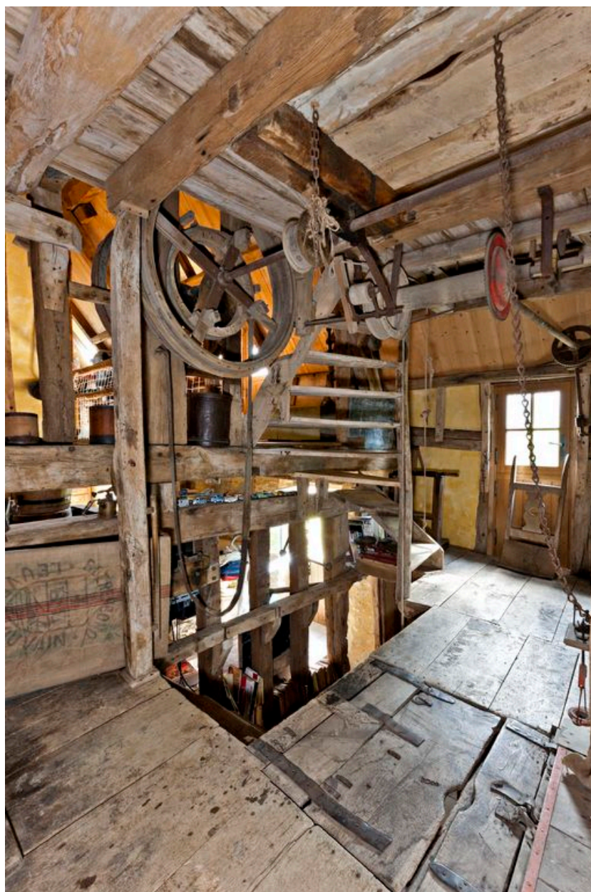
Vestiges d'un treuil lève-sacs (poules et trappe dans le plancher).
