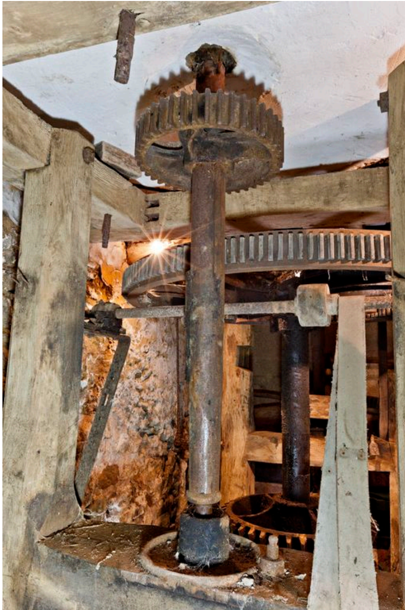
Détail de la poquerie : arbre latéral actionnant la paire de meules gauche
