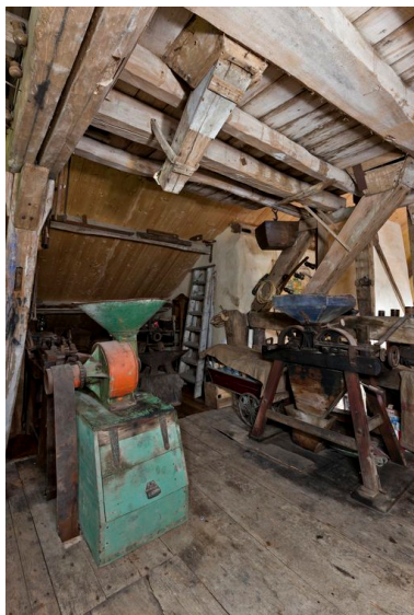
Les deux aplatisseurs à grains Phot. Yves Guillotin IVR52_20137200474NUCA
