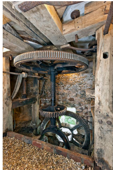
Détail de la poquerie : retour d'angle du moteur hydraulique Phot. Yves Guillotin IVR52_20137200483NUCA
