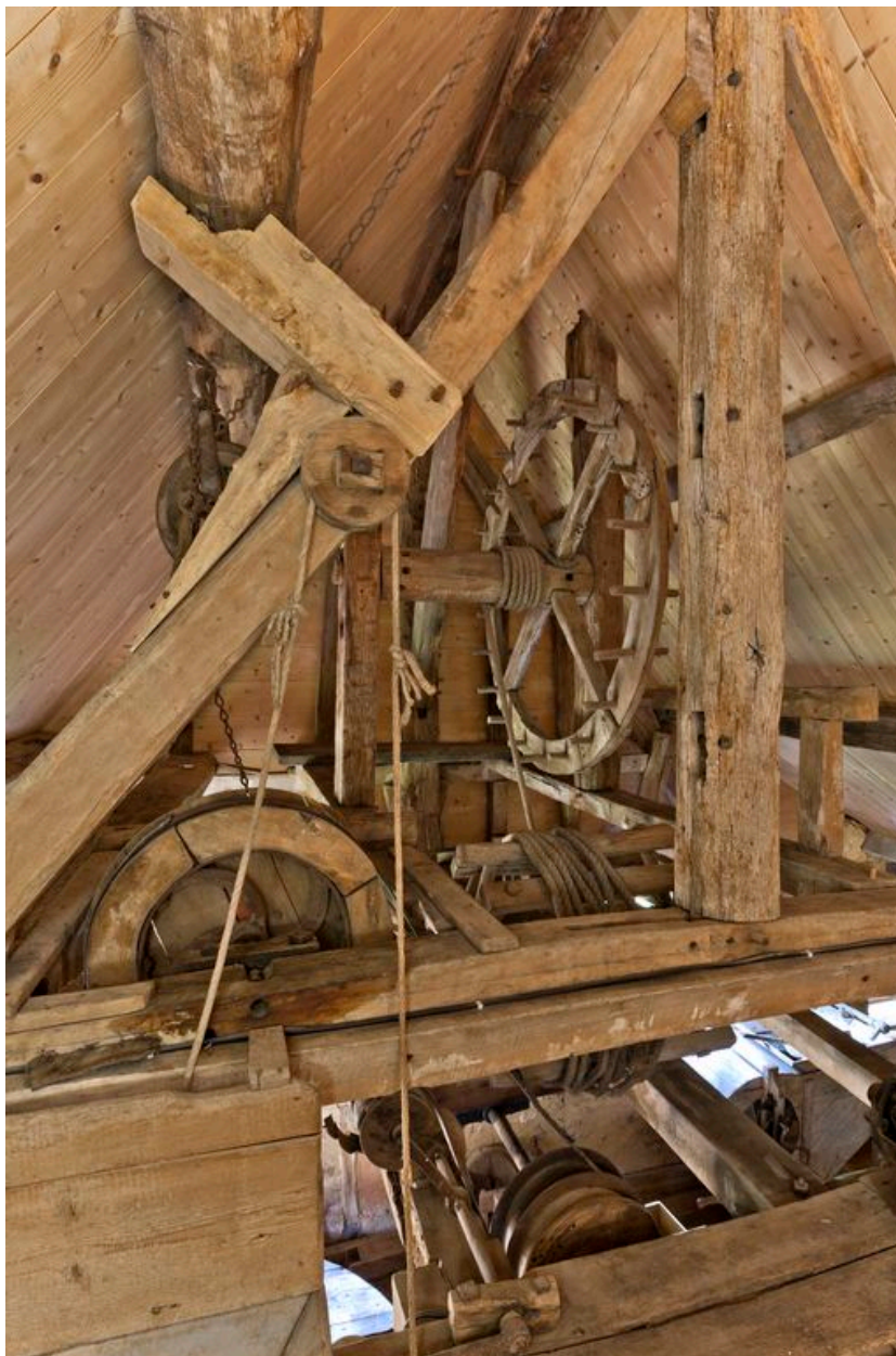
Treuil à lever les meules à l'étage de comble du moulin
