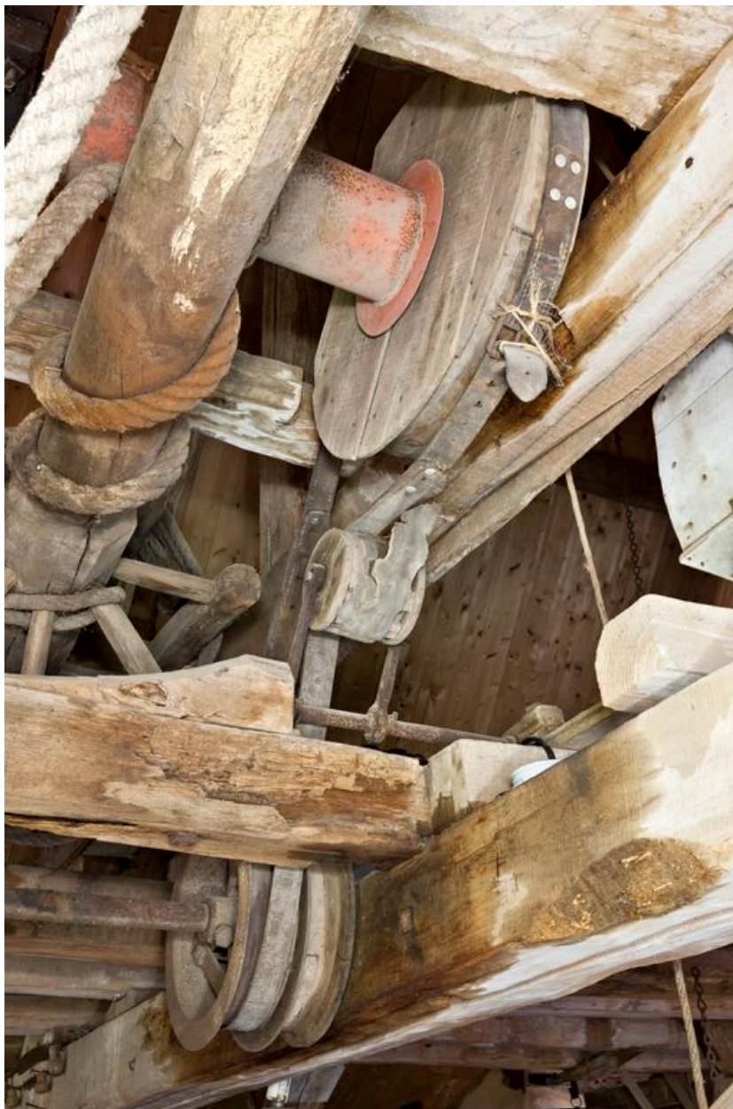
Embrayage à galets tendeur de la courroie du treuil monte-sac.
