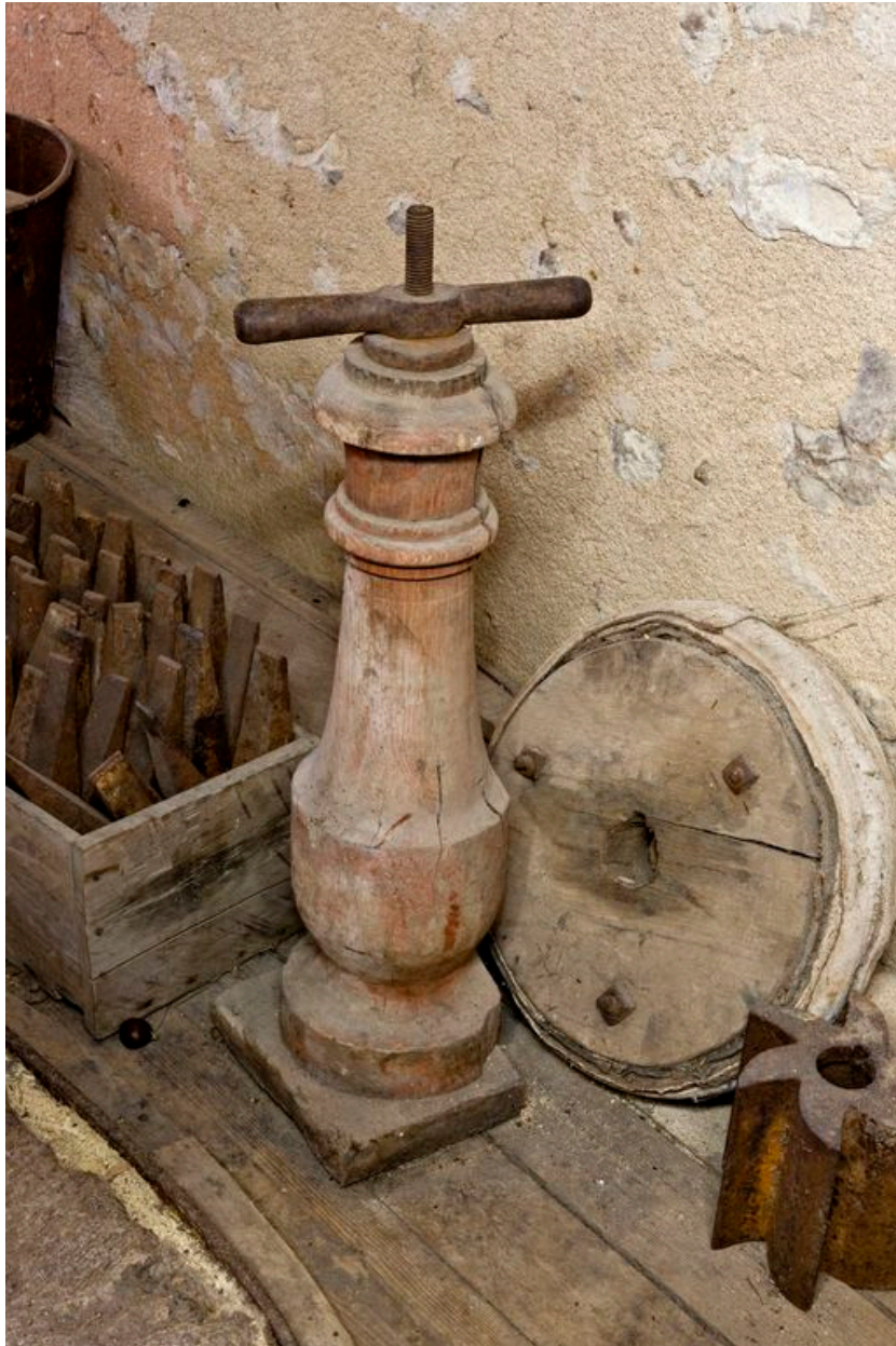
Commande de réglage de l'écartement des meules
