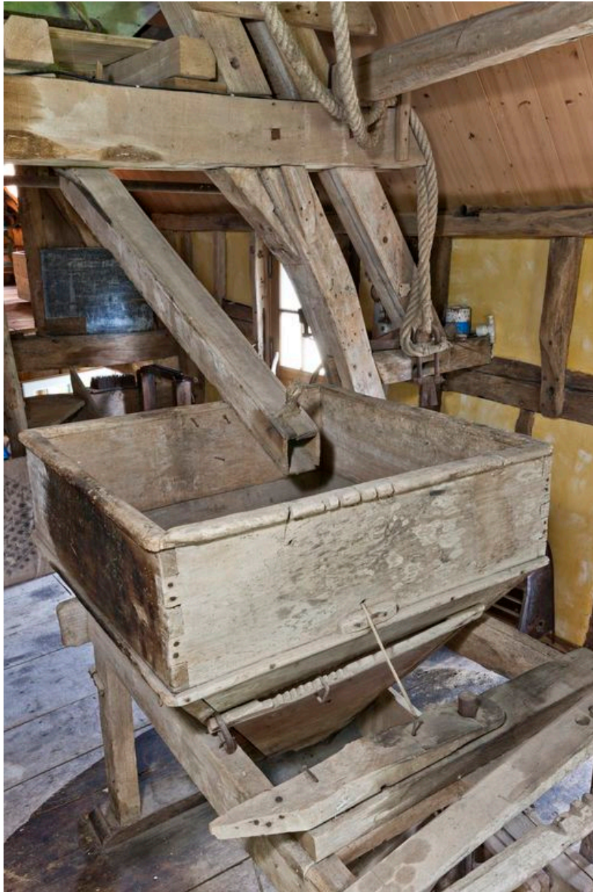
Détail de la trémie avec son anche
