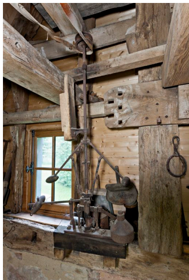
Le régulateur à boules Phot. Yves Guillotin IVR52_20137200473NUCA
