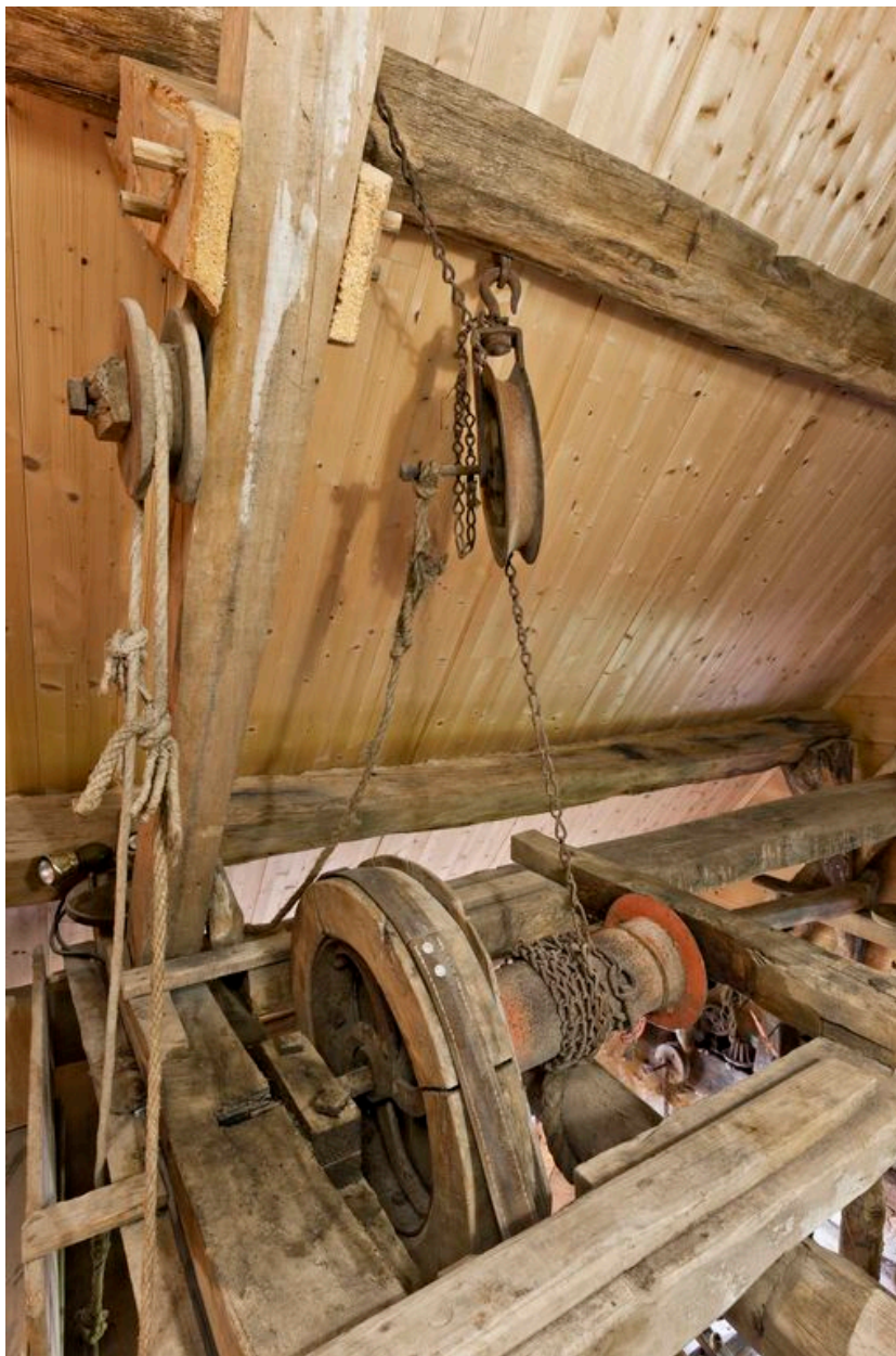
Partie d'un treuil lève-sac (?) à l'étage de comble
