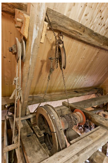
Partie d'un treuil lève- sac (?) à l'étage de comble Phot. Yves Guillotin IVR52_20137200468NUCA
