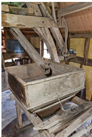
Détail de la trémie avec son anche Phot. Yves Guillotin IVR52_20137200478NUCA
