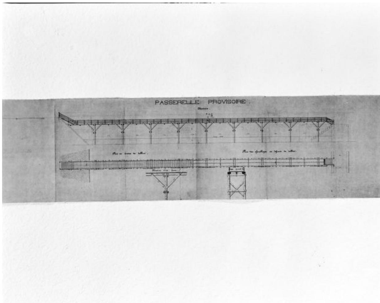
Passerelle provisoire, érigée en 1872 : élévation, plan au niveau du tablier, plan des assemblages au-dessous du tablier, élévation d'une ferme, coupe transversale.
