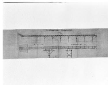
Passerelle provisoire, érigée en 1872 : élévation, plan au niveau du tablier, plan des assemblages
