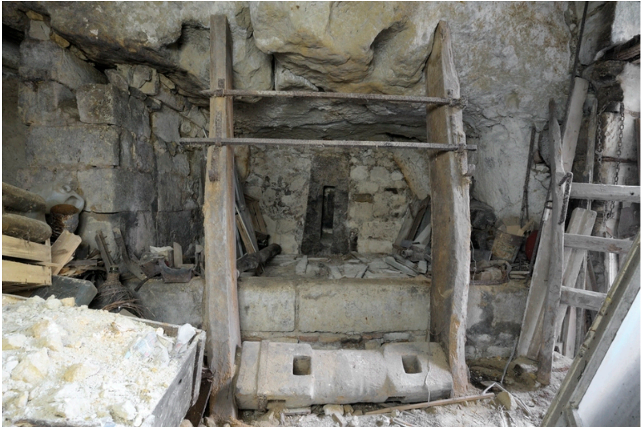
102-104, avenue des Roches. Abri troglodyte avec vestiges d'un pressoir casse-cou (avec montants en bois et cabestan).
