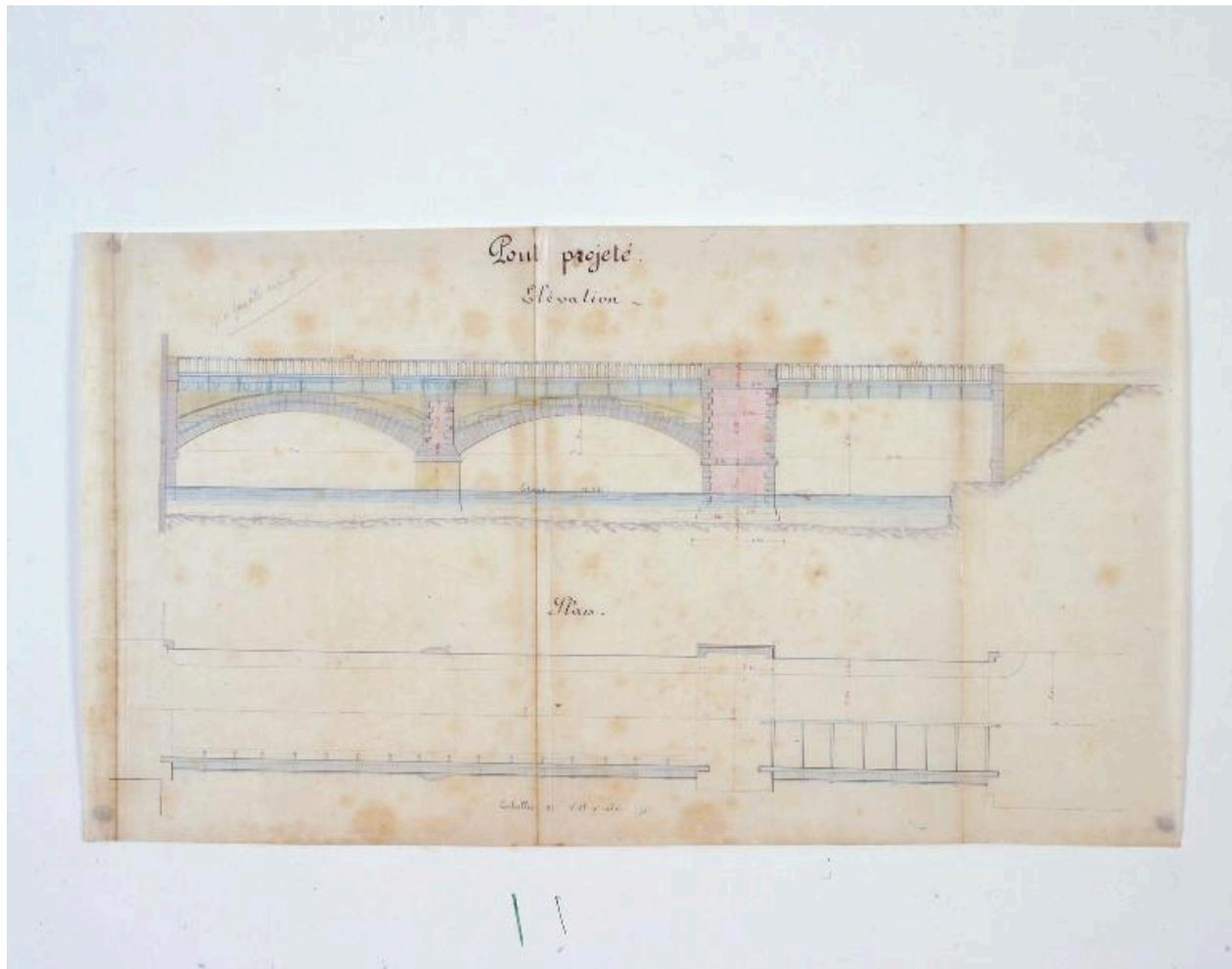
Projet (non réalisé) du 16 juin 1882 d'exhaussement et d'élargissement. Plan et élévation sud.
