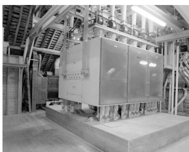
Le comble à surcroît, vu du nord-ouest : le plansichter Phot. François Lasa IVR52_20025300551X
