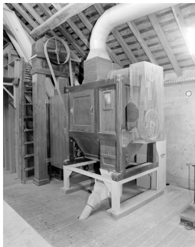
Comble à surcroît. Le nettoyeur de blé. Phot. François Lasa IVR52_20025300553X
