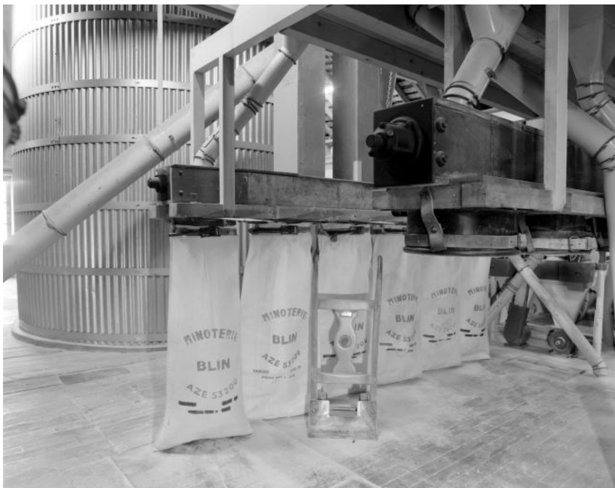
Comble à surcroît. L'ensacheur du remoulage.
