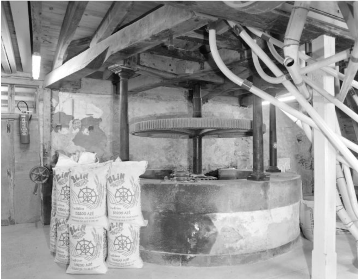
Rez-de-chaussée, partie ouest : la poquerie contenant le système de transmission commandé par la roue du large.
