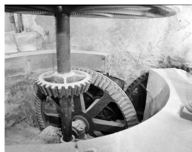
Détail du système de transmission commandé par la roue du large. Phot. François Lasa IVR52_20025300545X
