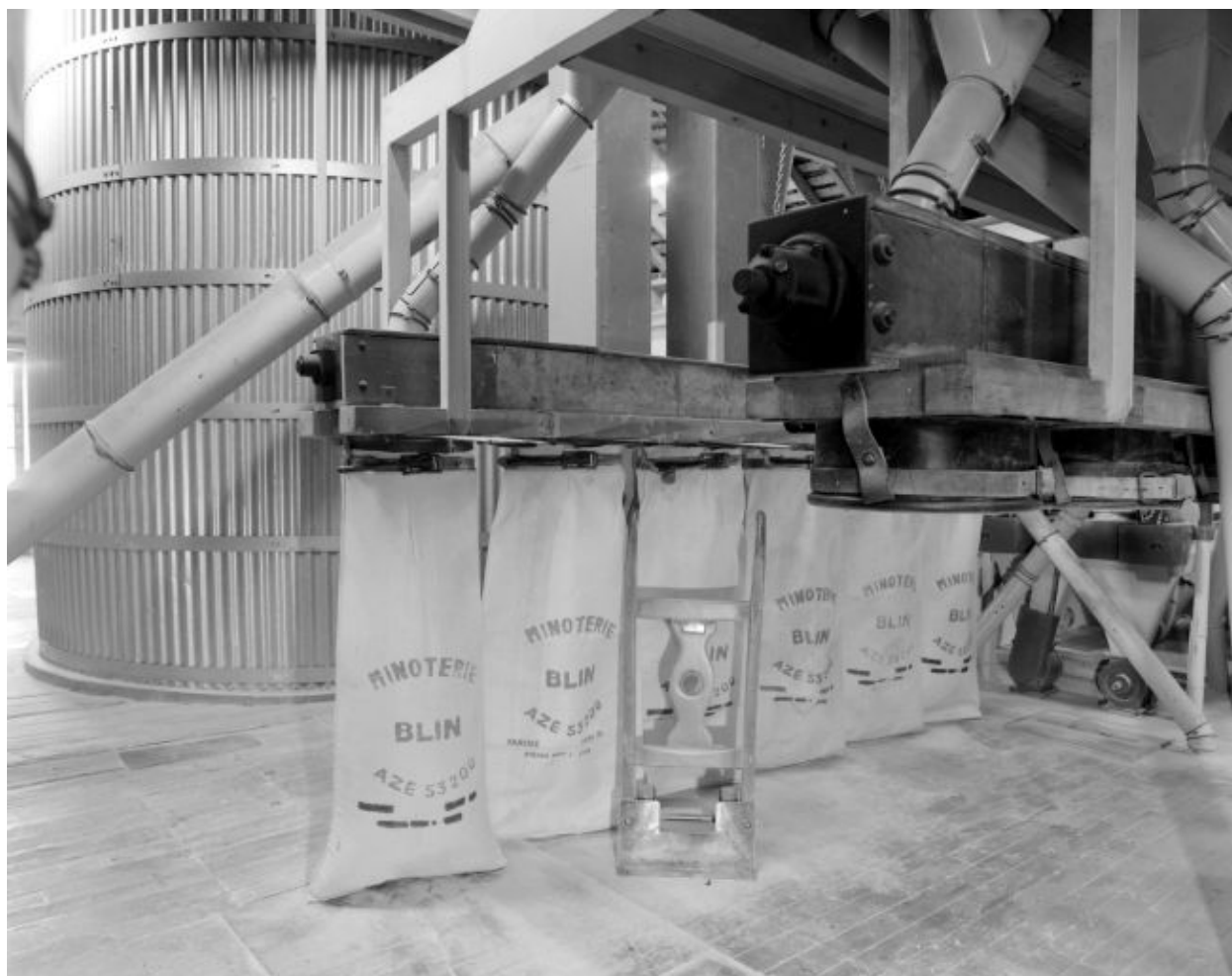
Comble à surcroît. L'ensacheur du remoulage.
