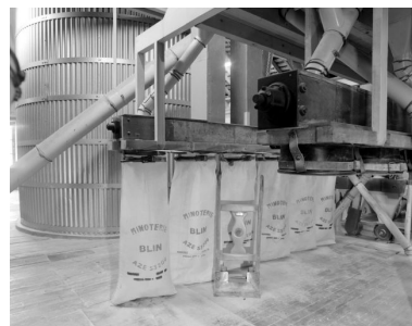
Comble à surcroît. L'ensacheur du remoulage. Phot. François Lasa IVR52_20025300552X
