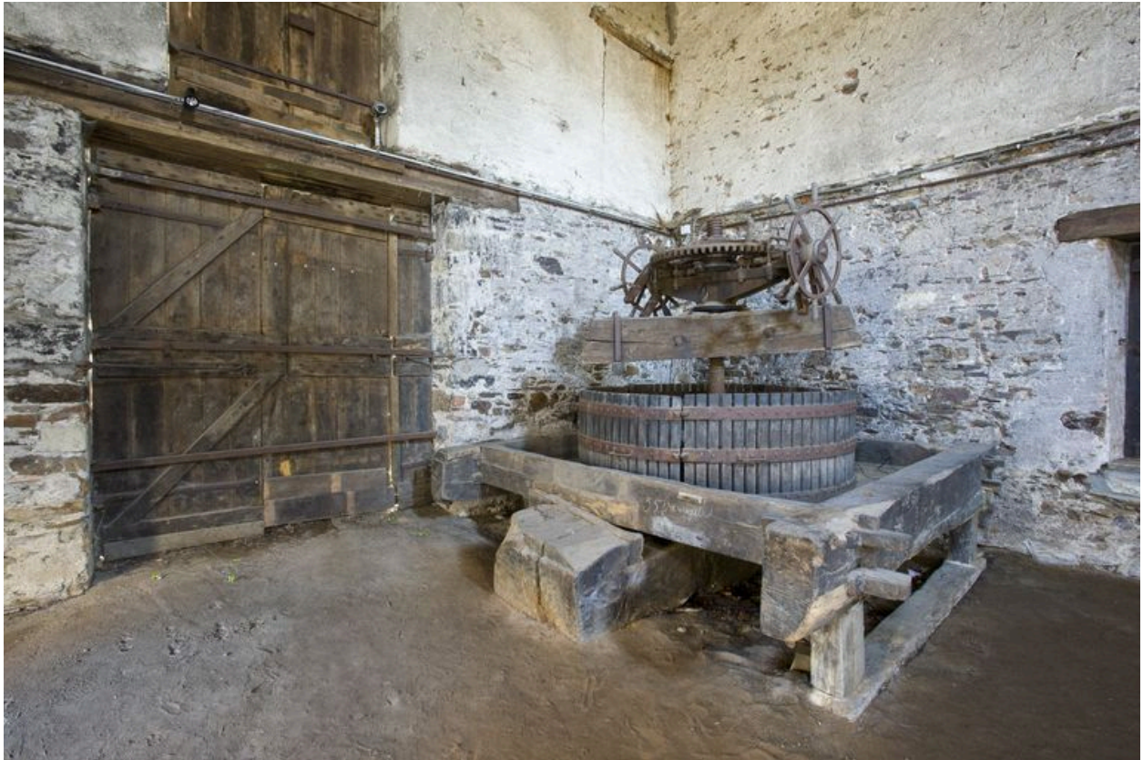
La cave : le pressoir à cage à cliquets, conçu par A. Dezaunay, vers 1845.
